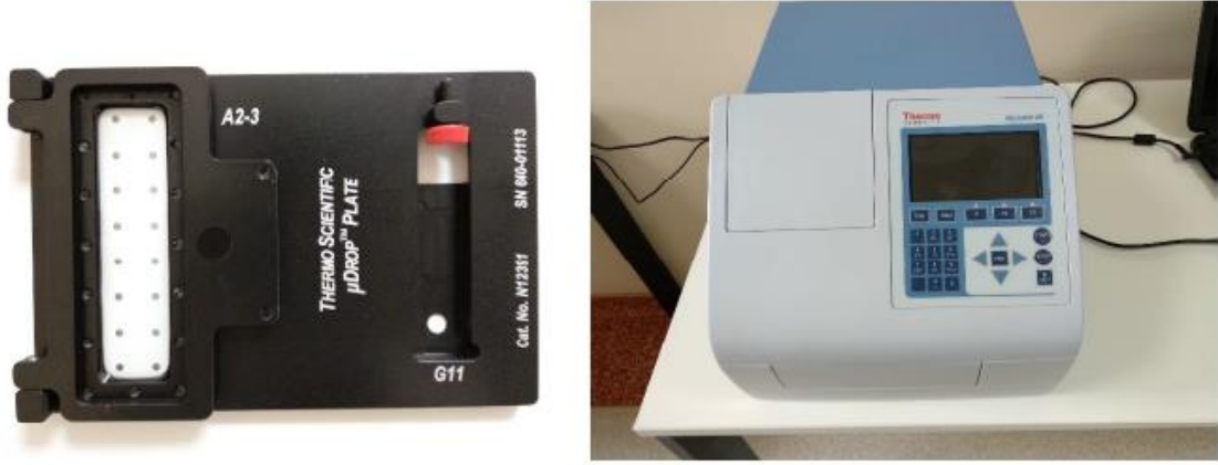
Resim 12: Mikro-hacim spektrofotometre cihazında ölçüm için kullanılan plate ve mikro-hacim spektrofotometre cihazı
