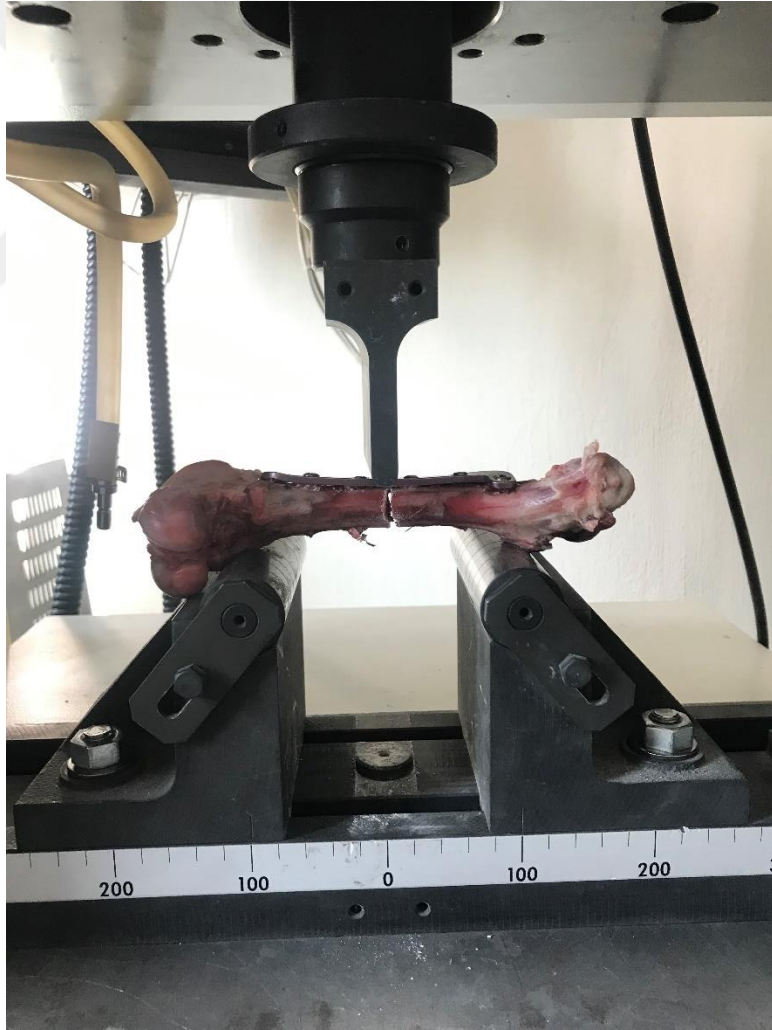
Resim 3.7: Bending Testi sırasında S plak ile tespiti saęlanmış materyal.
