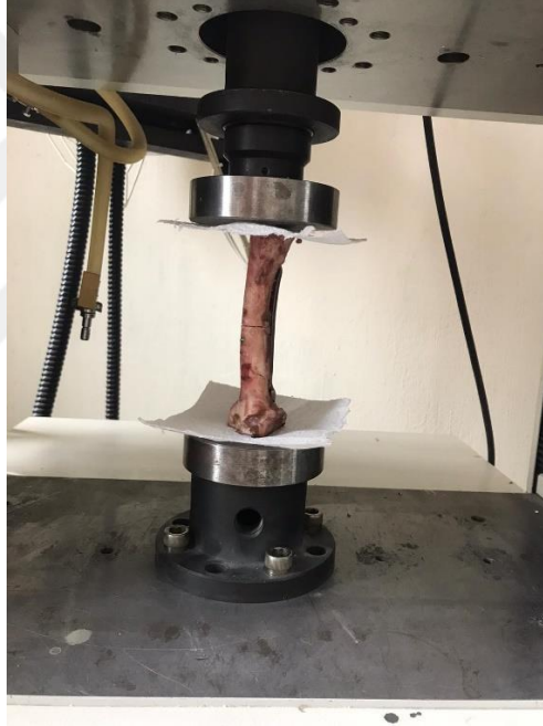
Resim 3.1: Aksiyel Kompresyon testi sırasında S plak ile tespiti sağlanmış materyal.
