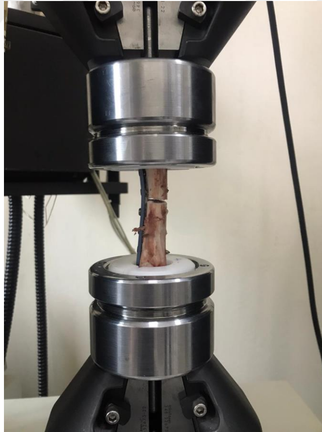
Resim 3.4: Distraksiyon (Gerilme) testi sırasında düz plak ile tespiti sağlanmış materyal.
