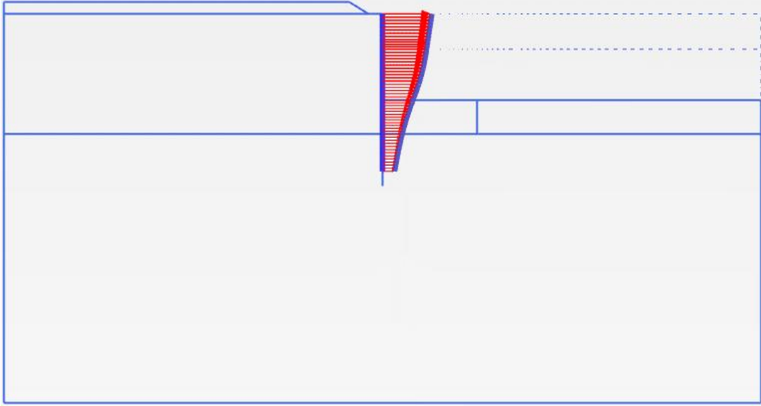
Şekil 5.14 : Kesit 4 için diyafram duvarda meydana gelen yatay deplasman dağılımı – maksimum 26 mm.
