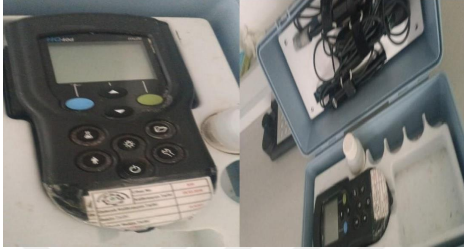
Şekil 3.7 pH Metre (HQ40D marka) ölçüm cihazı
