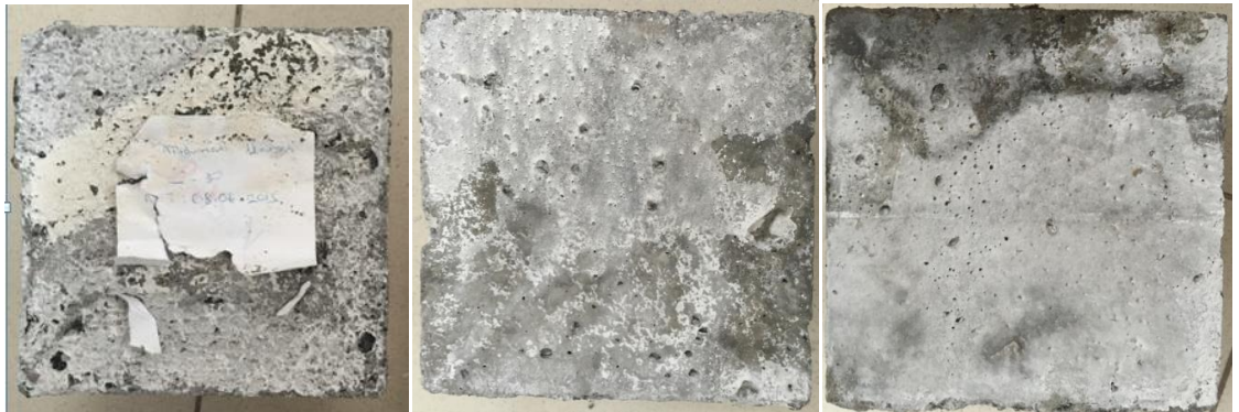
Şekil 4.7. 28 gün sonunda magnezyum sülfat çözeltisinde bekletilen silis dumanı ikameli numuneler
