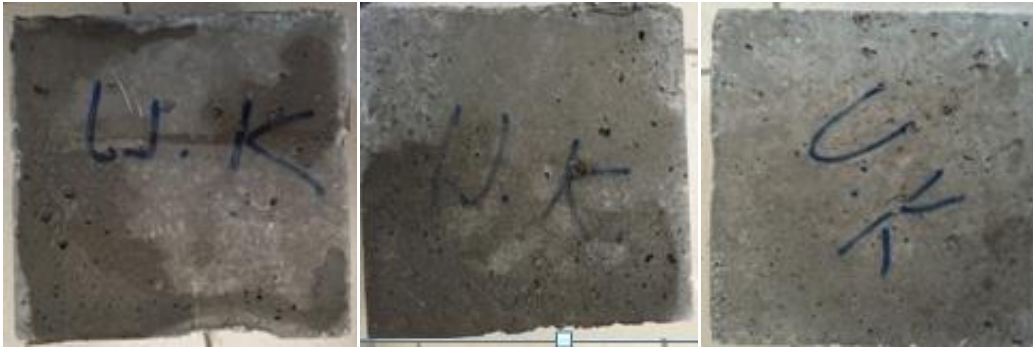
Şekil 4.3. 28 gün sonunda su küründe bekletilen uçucu kül ikameli numuneler
