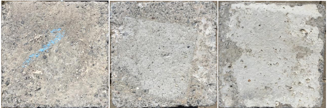
Şekil 4.13. 365 gün sonunda sülfat çözeltisinde bekletilen silis dumanı ikameli numuneler
