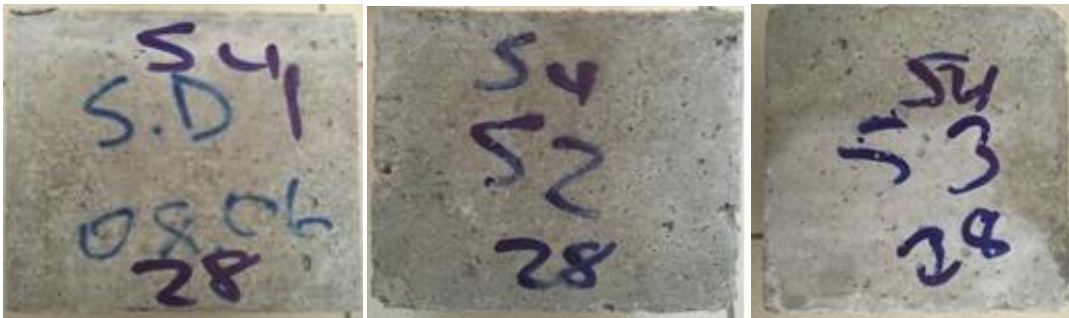
Şekil 4.4. 28 gün sonunda su küründe bekletilen silis dumanı ikameli numuneler
