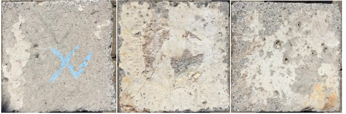
Şekil 4.12. 365 gün sonunda sülfat çözeltisinde bekletilen uçucu kül ikameli numuneler
