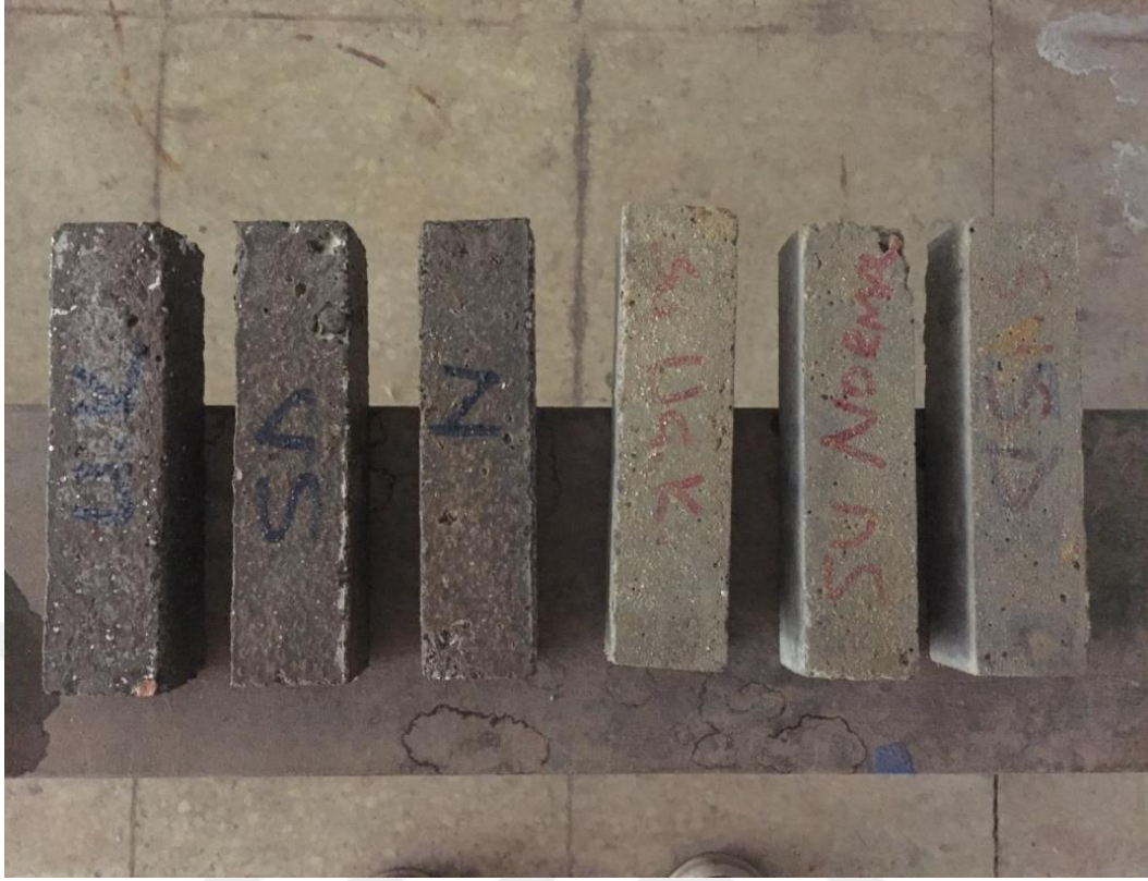
Şekil 3.6. 90 gün sonunda sülfat küründe (sol üçlü) ve su küründe bekletilen (sağ üçlü )numuneler
