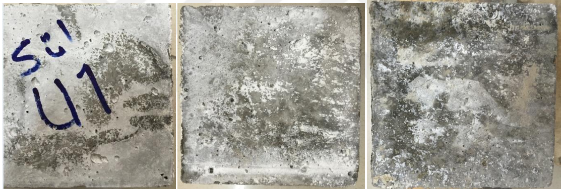
Şekil 4.6. 28 gün sonunda magnezyum sülfat çözeltisinde bekletilen uçucu kül ikameli numuneler
