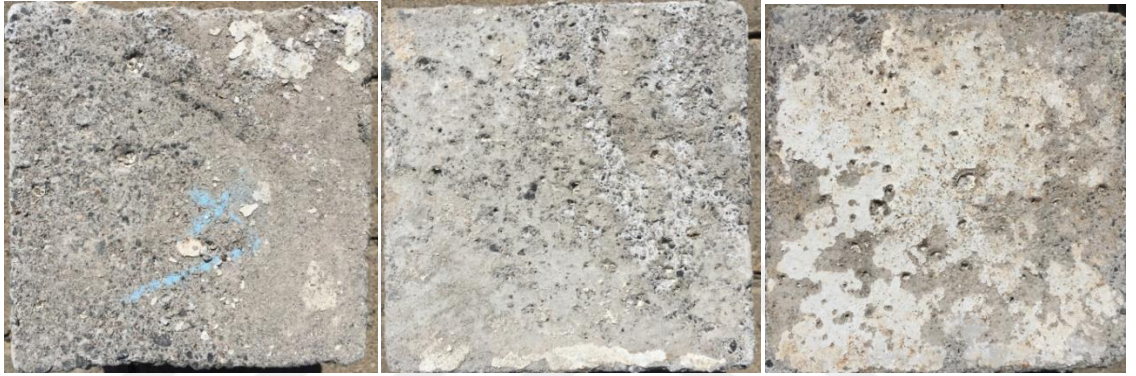
Şekil 4.11. 365 gün sonunda sülfat çözeltisinde bekletilen mineral katkısız numuneler
