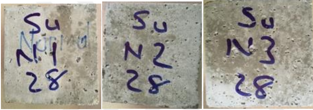
Şekil 4.2. 28 gün sonunda su küründe bekletilen mineral katkısız numuneler
