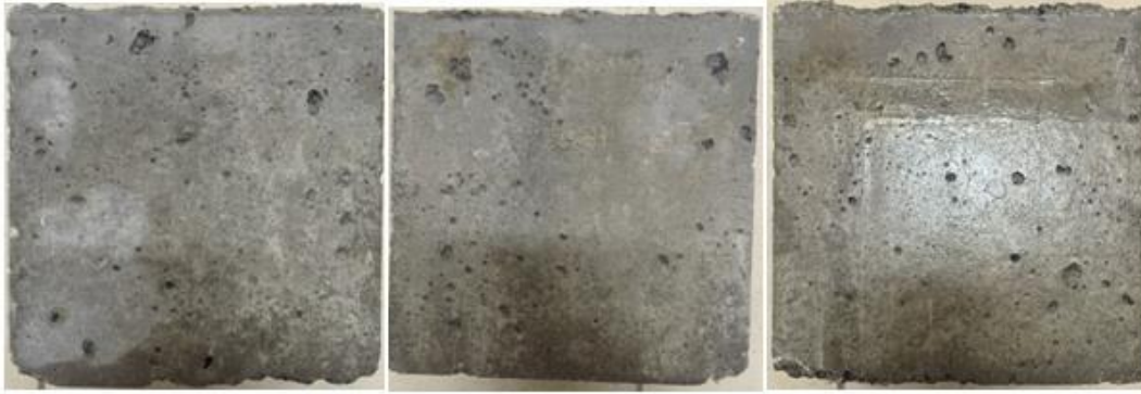
Şekil 4.8. 365 gün sonunda su küründe bekletilen mineral katkısız numuneler
