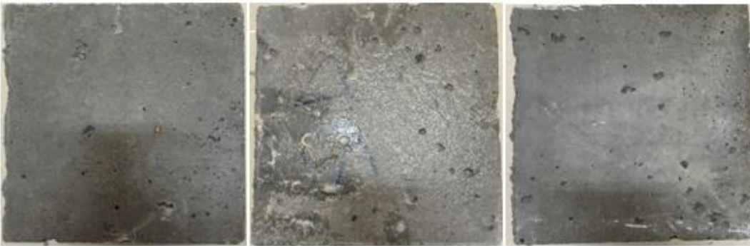
Şekil 4.10. 365 gün sonunda su küründe bekletilen silis dumanı ikameli numuneler
