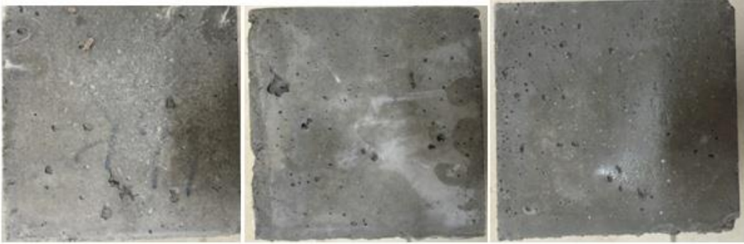
Şekil 4.9. 365 gün sonunda su küründe bekletilen uçucu kül ikameli numuneler
