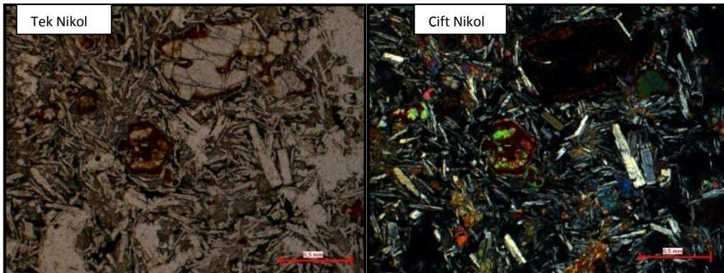
Şekil 4.28. Bg2-03 Nolu (masif bazalt) numunesine ait ince kesit görüntüleri
