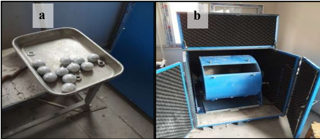
Şekil 3.102. Los Angeles parçalanma cihazı (a) ve bilyeleri (b)
