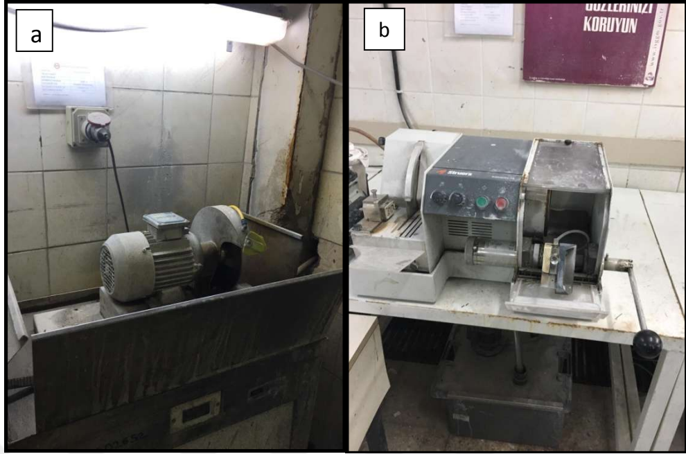
Şekil 3.106. Taşı büyük kesme (a) ve taştan ince parça hazırlama (b)
