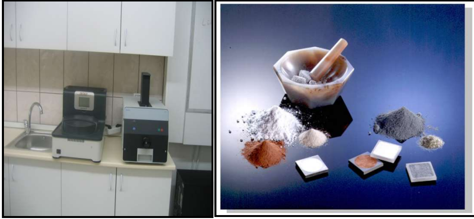
Şekil 3.111. Öğütme işlemi yapan bilyeli değirmen ve pudra kıvamındaki örnek numuneler (MTA 2018)
