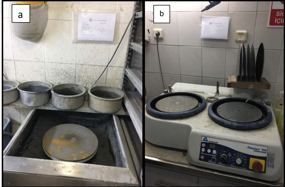
Şekil 3.107. Kaba aşındırma (a) ve taştan ince kesit hazırlama ve parlatma disk (b)
