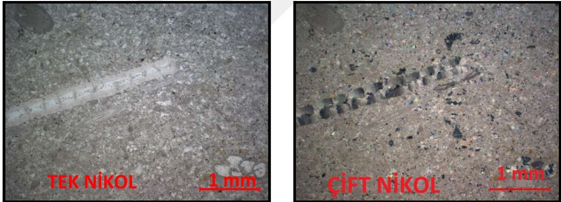
Şekil 4.24. S11-02 Nolu fosilli kireçtaşı (biomikrit) numunesine ait ince kesit görüntüleri
