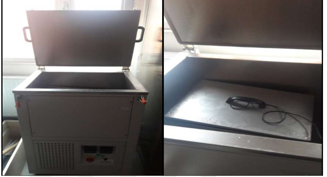
Şekil 3.103. Magnezyum sülfat cihazı
