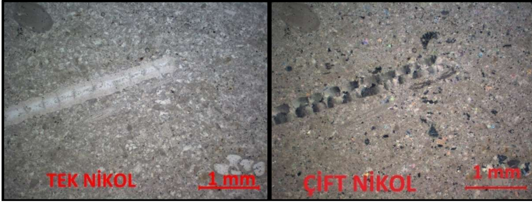
Şekil 4.25. S11-05 Nolu fosilli kireçtaşı numunesine ait ince kesit görüntüleri
