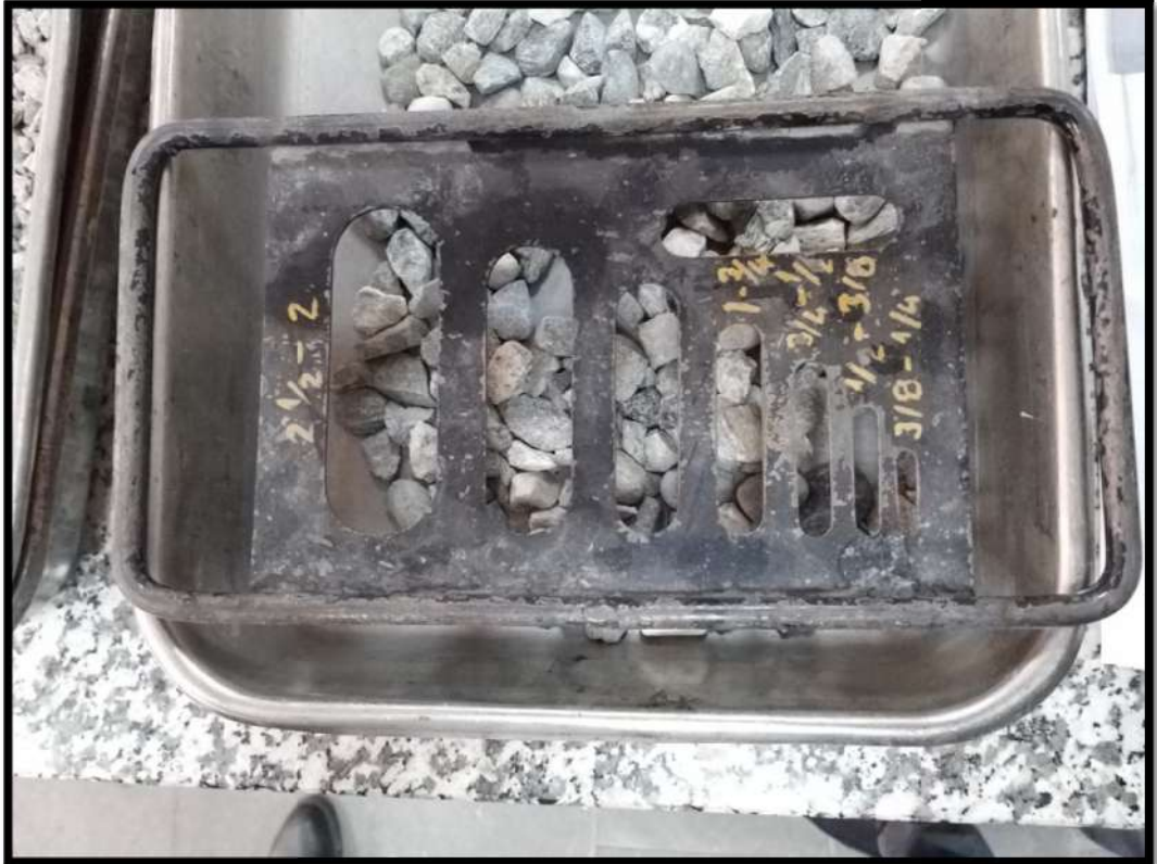
Şekil 3.105. Yassı tane yüzdesinin elek açıklıkları ve deneye uygulanan malzeme
