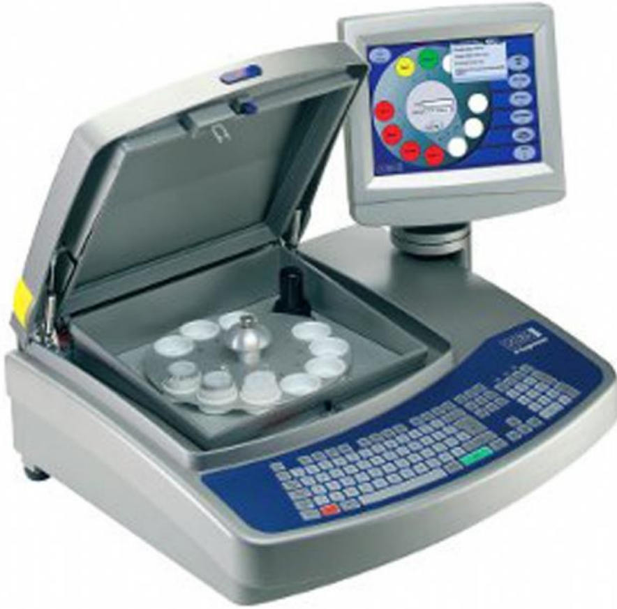
Şekil 3.24. Petrol içerisindeki kükürt oranının yüzde olarak tayininin yapıldığı cihaz.
