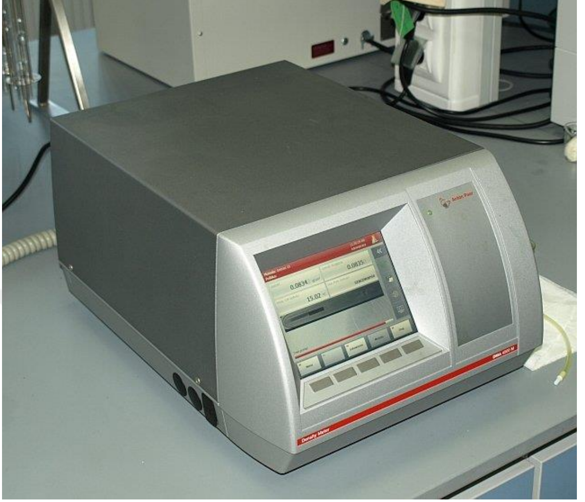
Şekil 3.23. Petrolün yoğunluğunun g/cm 3 cinsinden ölçüldüğü ASTM D4052 test metoduna uygun cihaz
