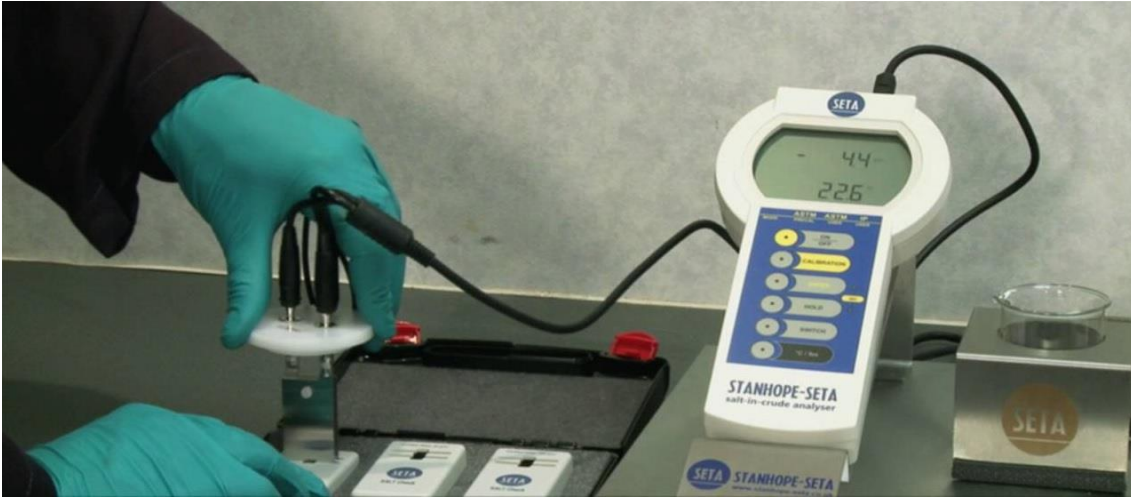
Şekil 3.25. Petrol tuzluluğunun ptb cinsinden ölçümünün yapıldığı ASTM D3230 test metoduna uygun cihaz
