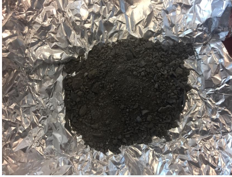
Şekil 3.3. DMDA kuyusundan alınan Dadaş Formasyonu'na ait kesinti örneği
