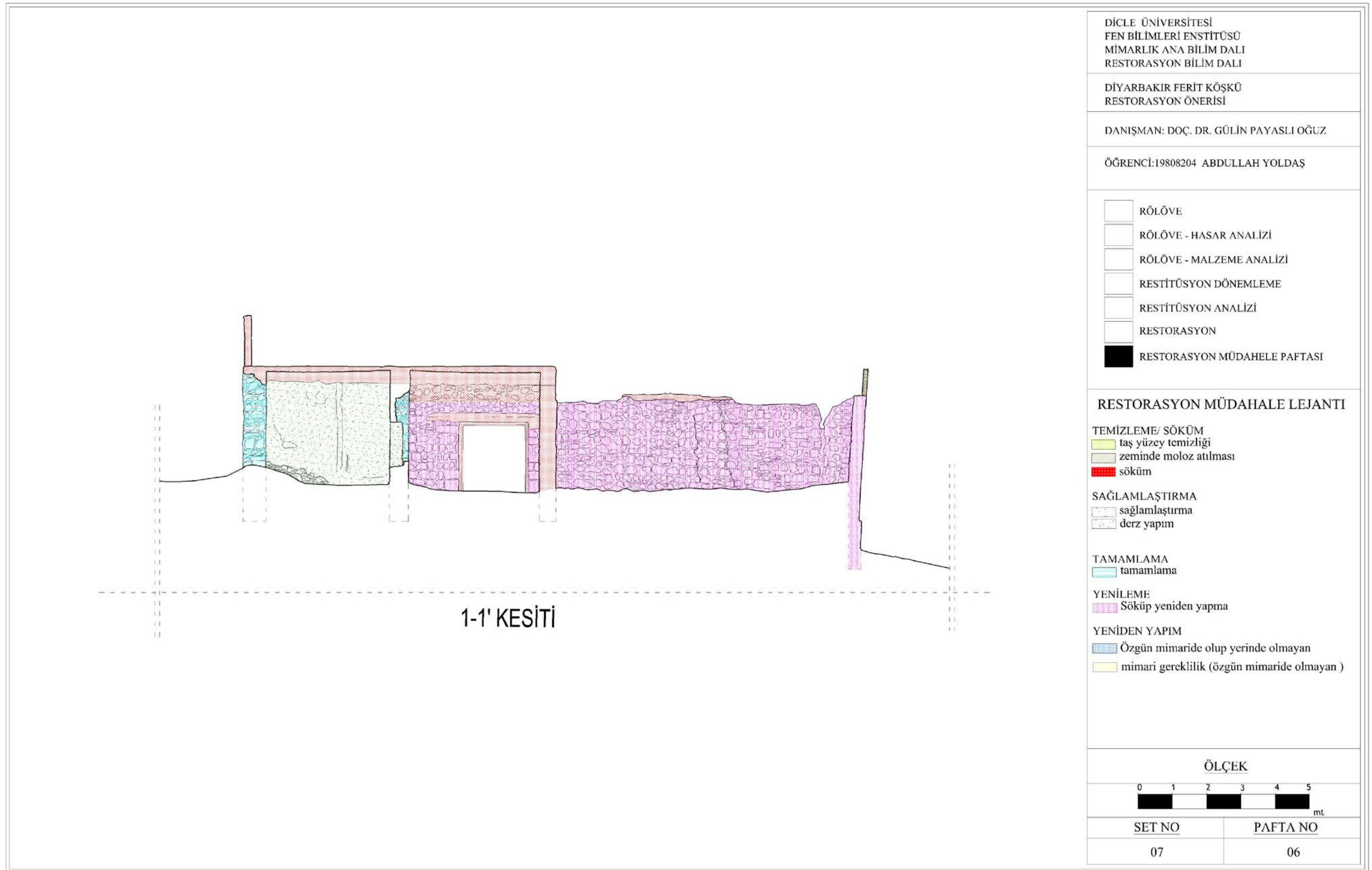
Şekil 6.23 1-1' kesiti restorasyon müdahale çizimi
