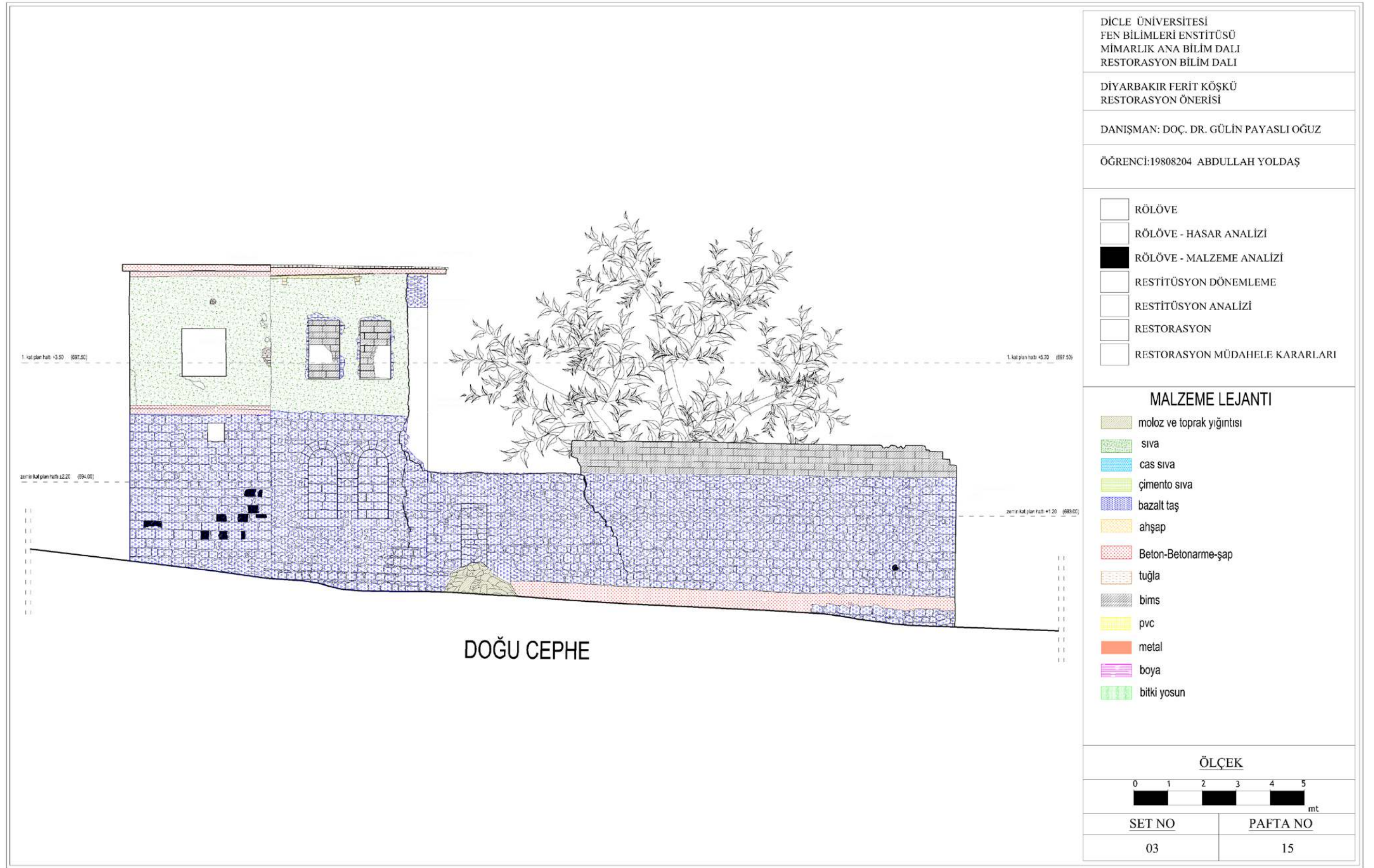
Şekil 4.160 Doğu cephe malzeme analizi
