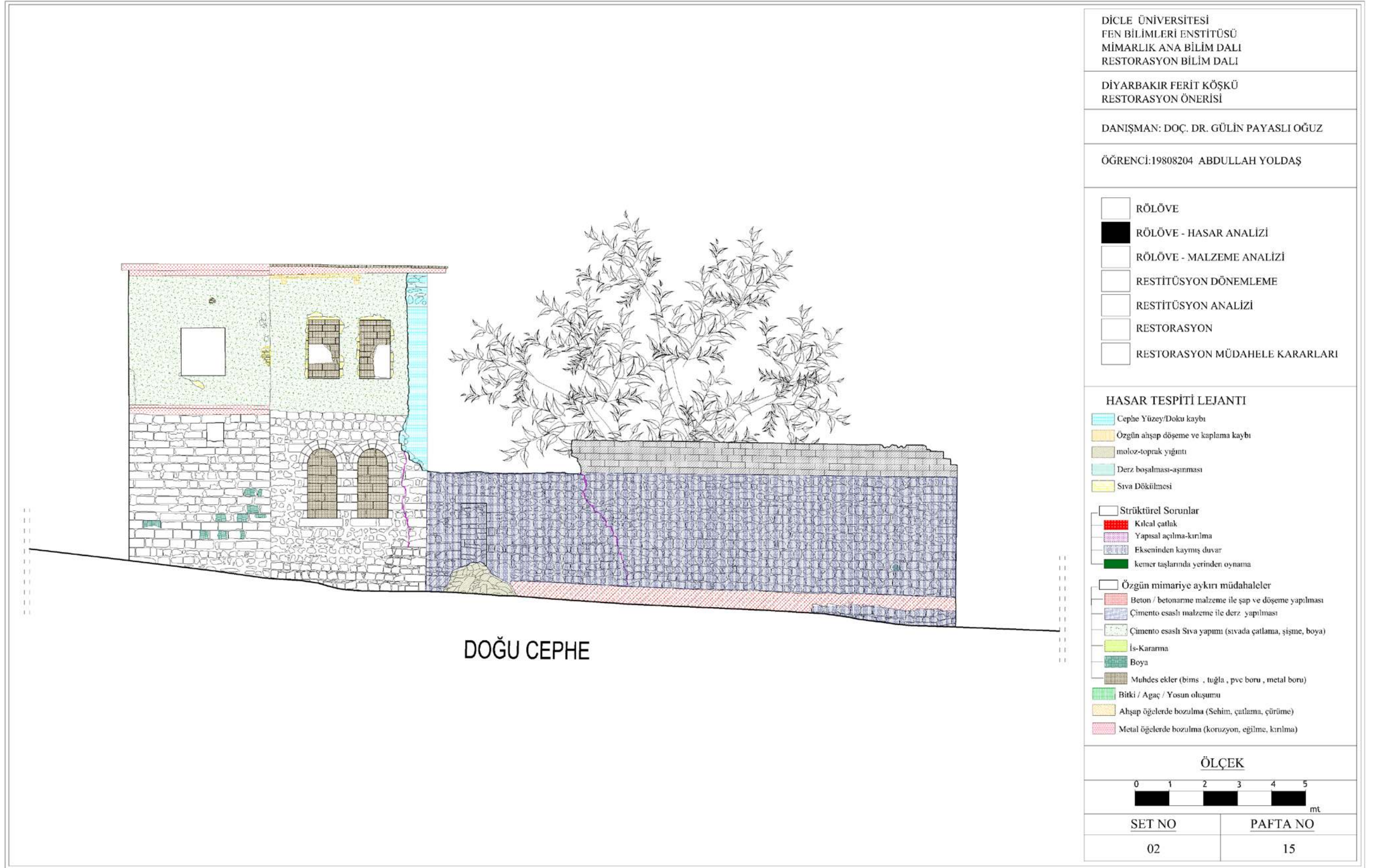
Şekil 4.143 Doğu cephe hasar analizi
