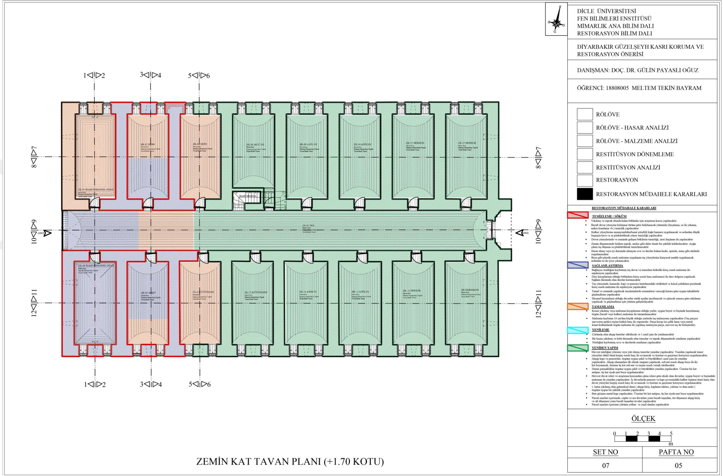
Şekil 6.20 Zemin Kat Tavan Planı, Restorasyon Müdahale Çizimleri
