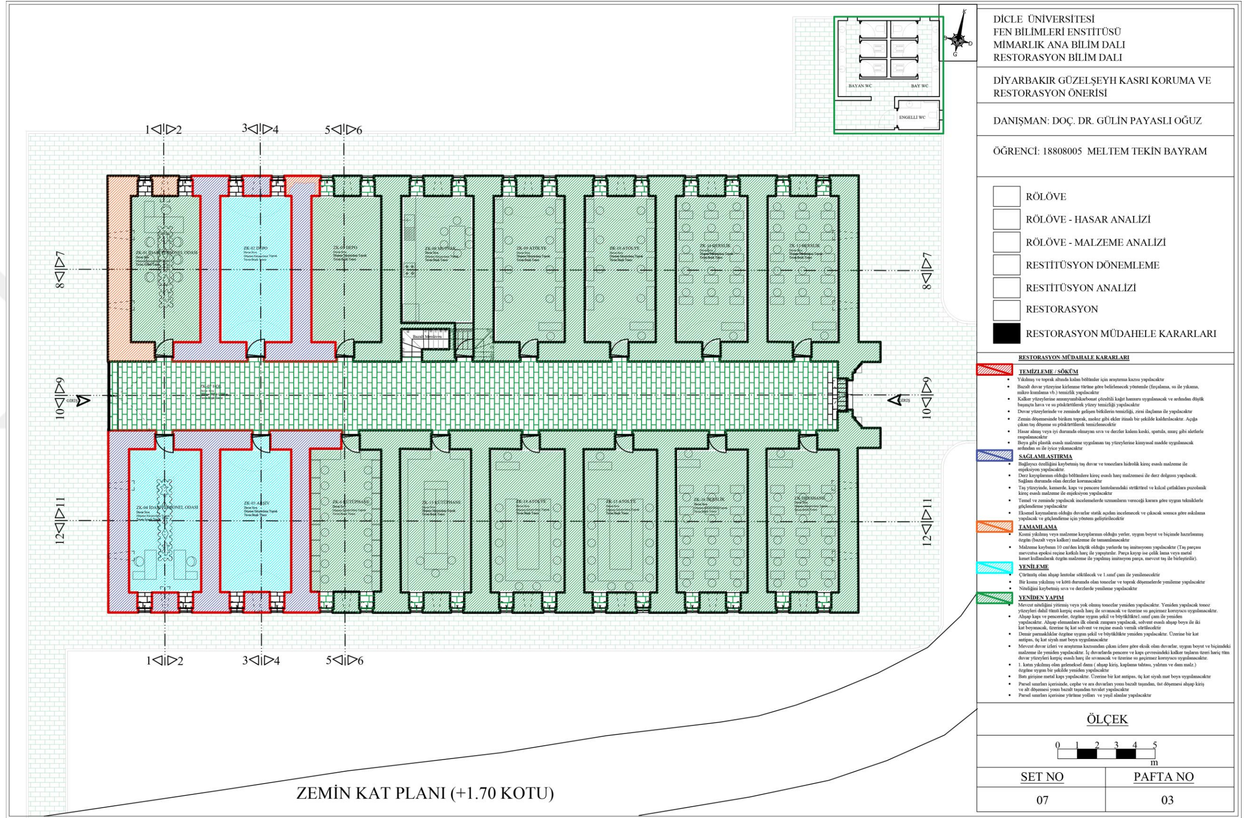
Şekil 6.18 Zemin Kat Planı, Restorasyon Müdahale Çizimleri
