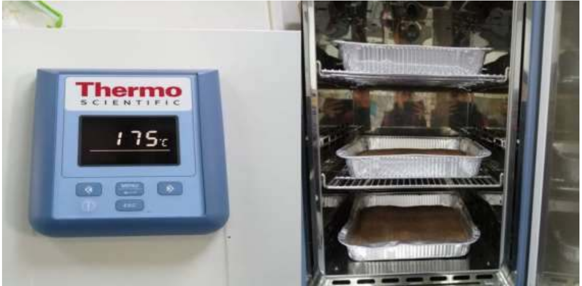
Şekil 3.6. Etüv içerisinde 175^{\circ}\text{C} 'de steril edilen topraklar
