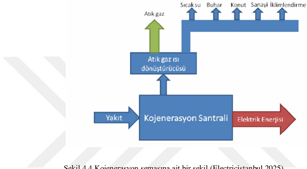
Şekil 4.4 Kojenerasyon şemasına ait bir şekil (Electricistanbul,2025)
