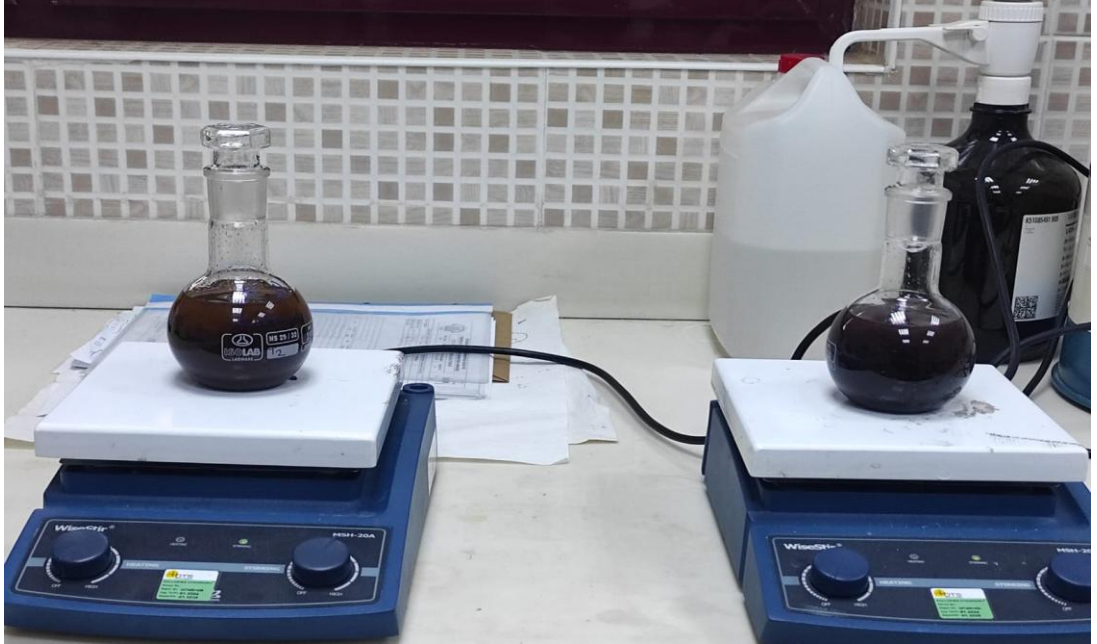
Şekil 3.5 Dut örneklerin çözücü içinde çalkalama işlemine tabi tutulduğu halleri
