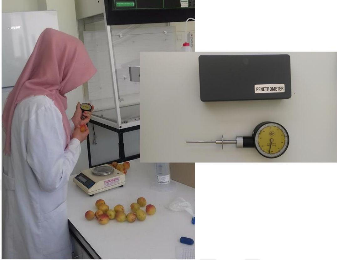
Şekil 4.1. Penetrometre ile meyve sertliğinin ölçümüne ait fotoğraf
