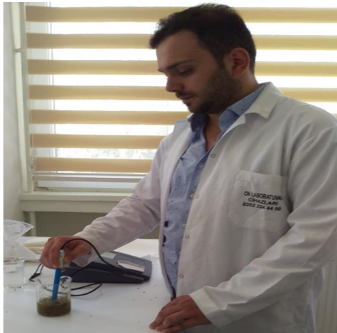
Şekil 7. Silaj da pH değeri ölçümü
