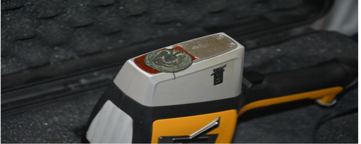
Şekil 3.15 P-EDXRF cihazı ile ölçüm yaparken filtre kullanımı
