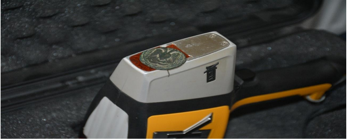
Şekil 3.15 P-EDXRF cihazı ile ölçüm yaparken filtre kullanımı
