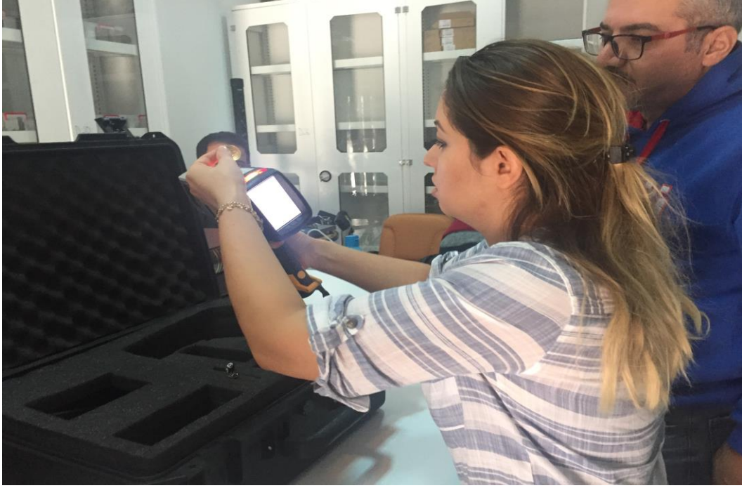
Şekil 3-6: Taşınabilir X-ışını floresans (P-XRF) spektrometrenin kullanımı - Diyarbakır Müzesi
