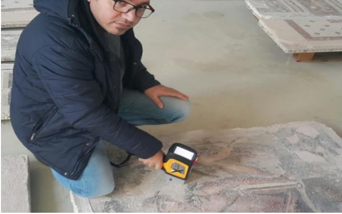
Şekil 3-7: P-XRF Cihazının sahada kullanımı
