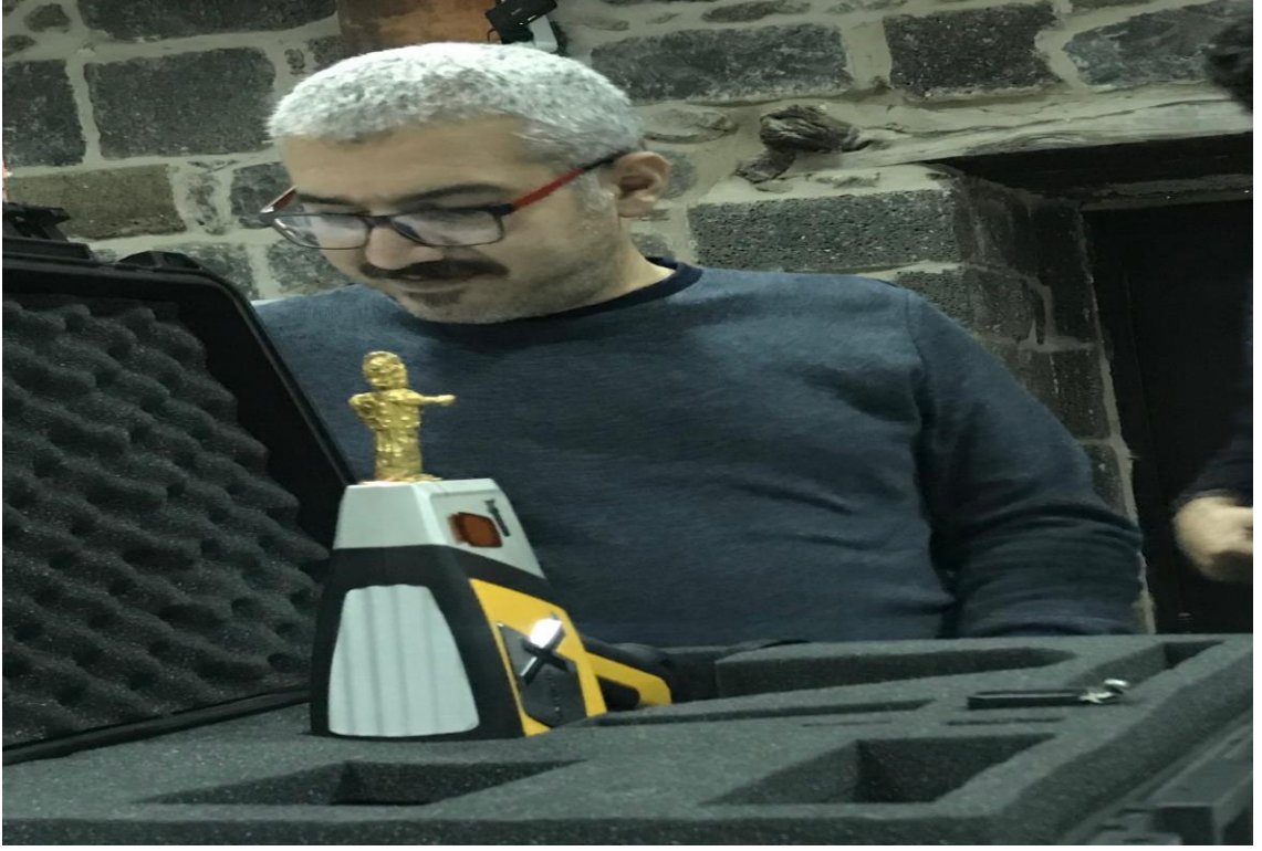
Şekil 3-5: Taşınabilir X-ışını floresans (P-XRF) cihazı özel çantası-Diyarbakır Müzesi
