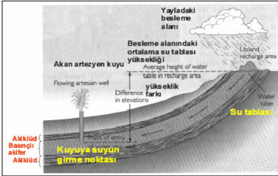
Şekil 2.7 Basınçlı akifer ve artezyen [27]
