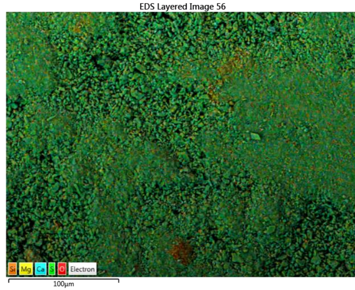
Şekil 3.58.Örnek-6 hamurunda 100 μm ölçekli SEM görüntüsü üzerindeki element dağılımı.
