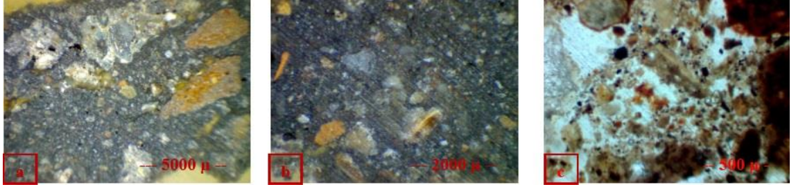
4 numaralı örneğe ait; a) Stereo mikroskop genel doku, b) Stereo mikroskop detayı, c) Polarizan mikroskop görüntüsü.
