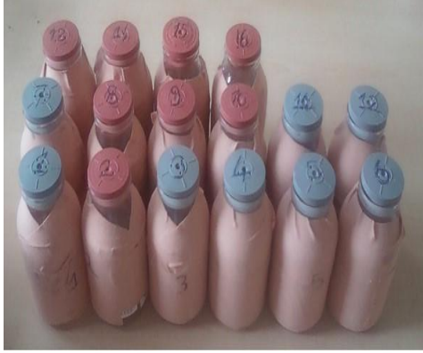
Şekil 8a. Eşik testi için %4 lük n-bütanolden geometrik seriler halinde dilüe edilerek hazırlanan çözeltiler
