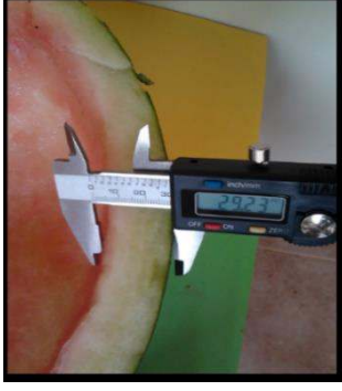
Şekil 3.4. Dış kabuk kalınlığı ölçümü
