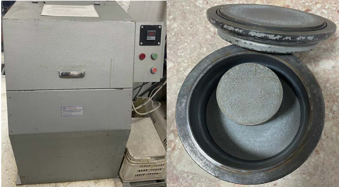
Şekil 3.6 Laboratuvar tipi halkalı değirmen.
