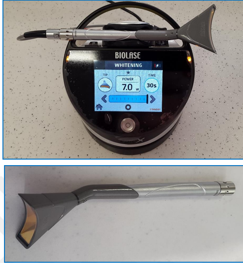
Şekil 3. 1: 940 nm dalga boyunda diyot lazer ve ucu
