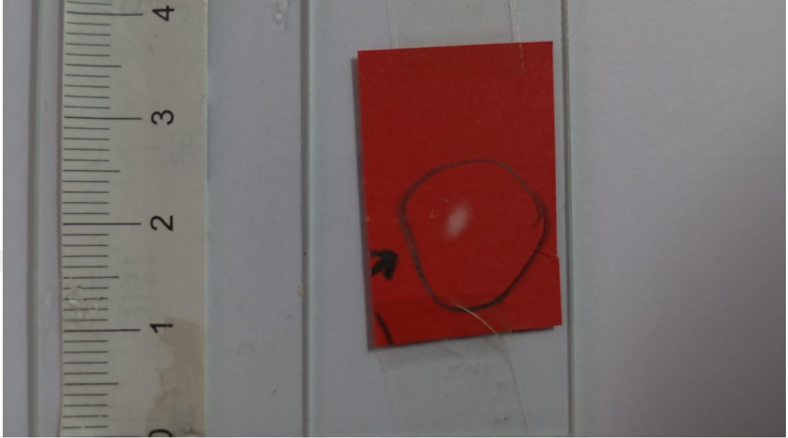
Şekil 4.11. 30 dakika boyunca lazer güneş ışığı uygulanan kırmızı mukavvada oluşan solma
