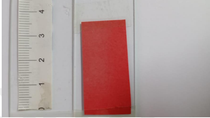
Şekil 4.27. 24 saat boyunca lazer güneş ışığı uygulanan kırmızı mukavvada oluşan yaşlanma
