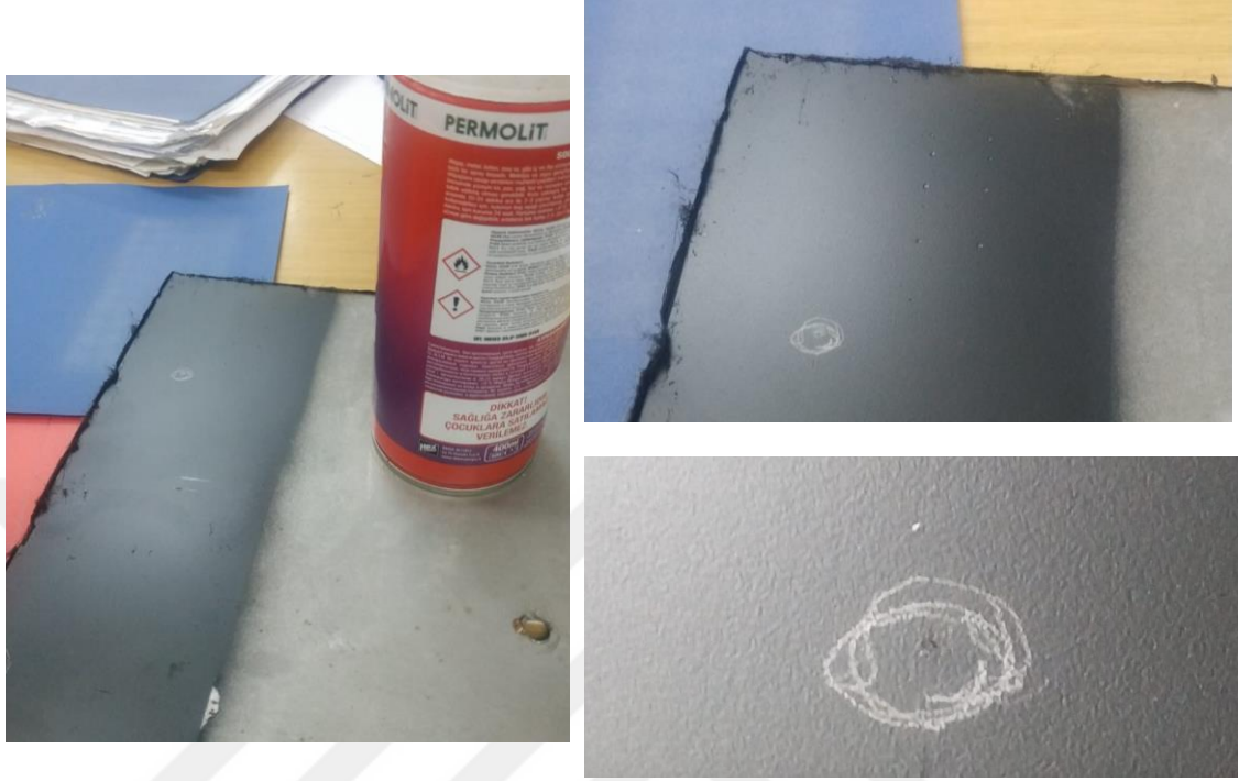
Şekil 4.19. 24 saat boyunca lazer güneş ışığı uygulanan siyah boyalı sacdaki yaşlanma
