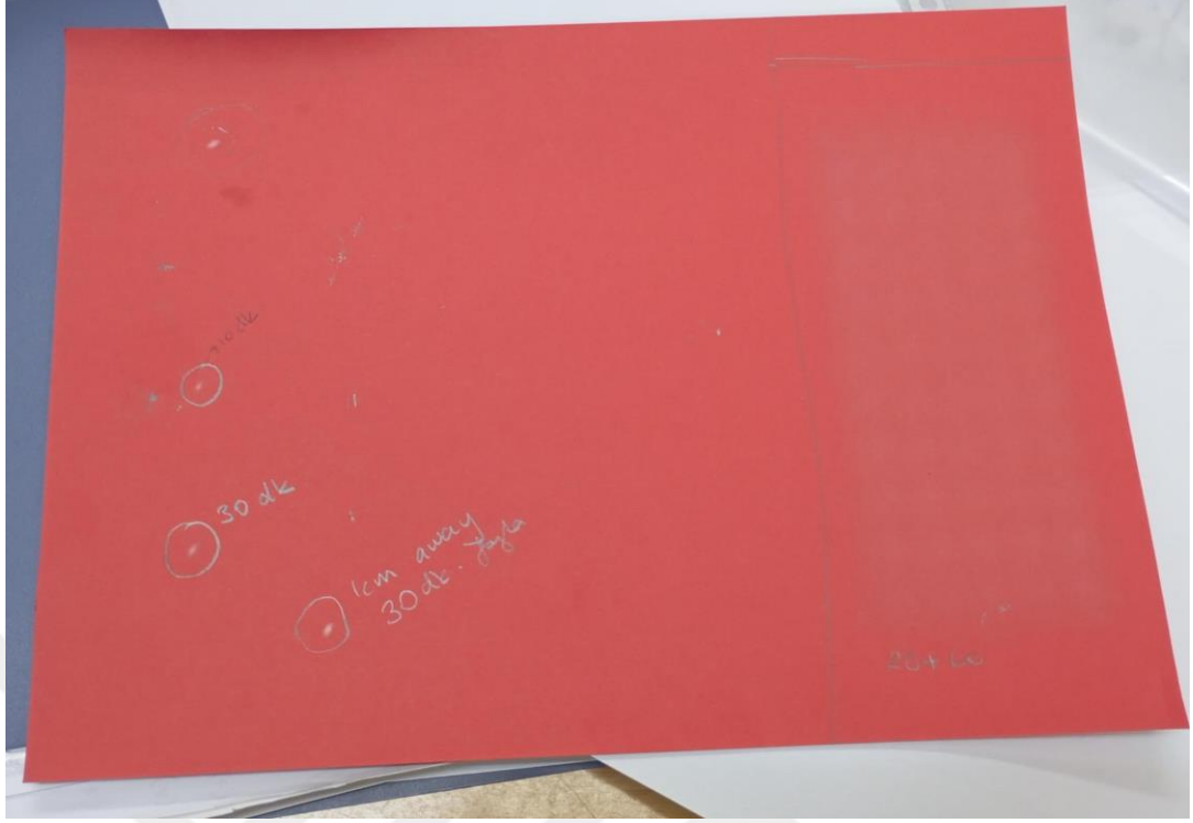
Şekil 4.9. Solda lazer güneş ışığı, sağda led projektörle yapılan yaşlandırmalar. Lazer 30 dakika led projektör ise 24 saat boyunca pozlanmıştır.
