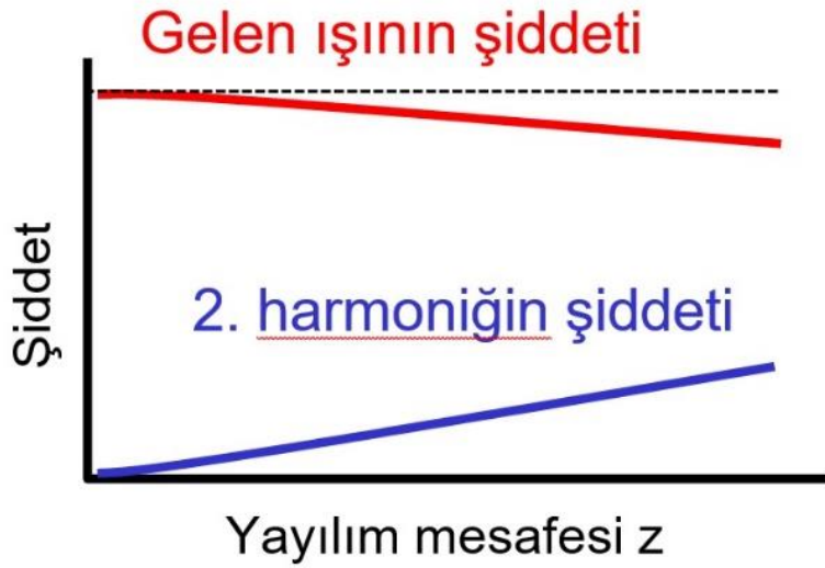
Şekil 2.22 Işın doğrusal olmayan ortam boyunca yayıldıkça şiddeti azalır ve 2. harmonik dalganın şiddeti (başlangıçta sıfır) artar.
