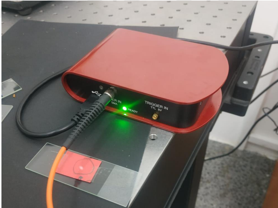
Şekil 4.10. Thorlabs CCS model spektrometre, esnek fiber sensör aparatıyla lazer benzeteçle yaşlandırılan numunenin incelenmesi.
