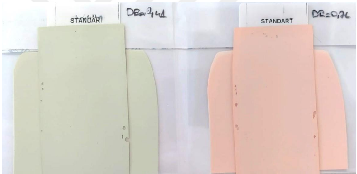
Şekil 3.5 Orta PVC bir boyada açık renklerde 4 döngüsonrası gözlemlenen solma ve yaşlanma Panellerinin her döngü sonrası L,a,b değerleri okunarak kaydediler.
