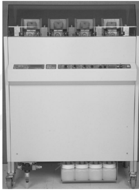
Şekil 2.21. Instron-Stanmore dört istasyonlu diz simülatörü [25]
