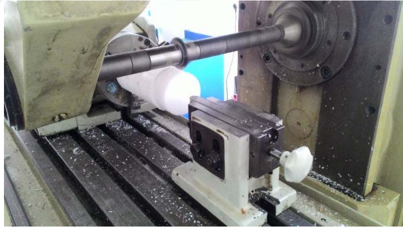
Şekil 3.56. Tibial dönme karşılık dişlisi açımı
