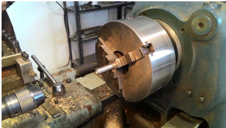
Şekil 3.44. Burçlu kızak yatak imalatı
