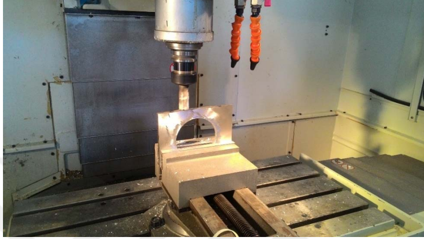
Şekil 3.47. Servo motor için bağlantı flanş üretimi
