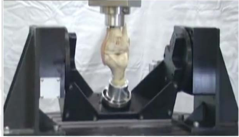
Şekil 2.24. Cleveland Klinik diz eklem simülatörü [9]
