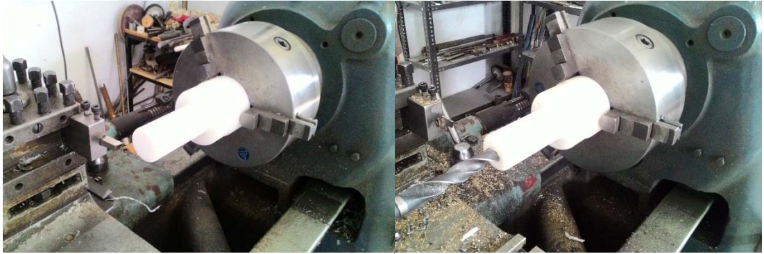
Şekil 3.50. Eksenel kuvvet milinin talaşlı imalatı
