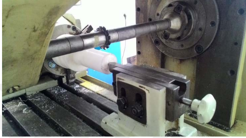
Şekil 3.55. Hareketli parça düz dişli açımı
