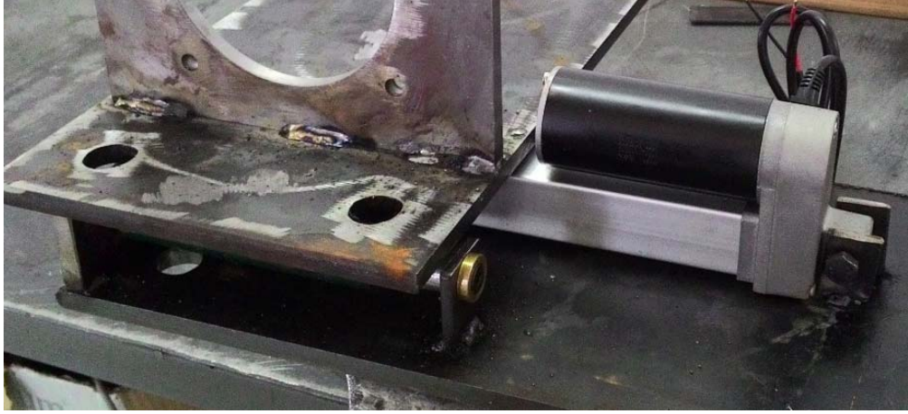
Şekil 3.46. Öne/arkaya hareketi için sistemin montaj görüntüsü
