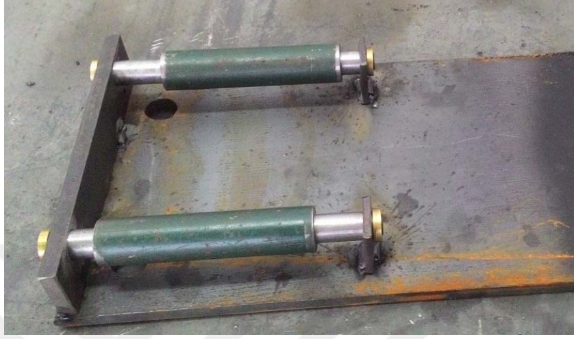
Şekil 3.45. Burçlu kızak montaj görüntüsü
