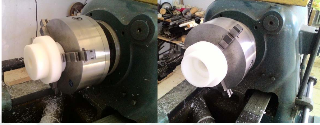
Şekil 3.49. Eksenel kuvvet mil yatağının talaşlı imalatı
