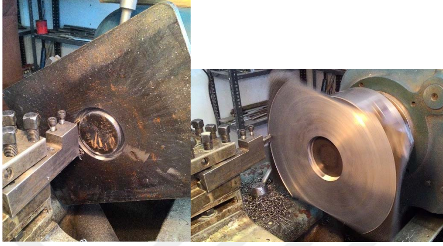
Şekil 3.53. Eksenel kuvvet mil yatak tablası imalatı
