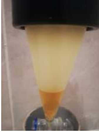
Şekil 5.3. 4 Saat Dinlendirilmiş Biyodizel
