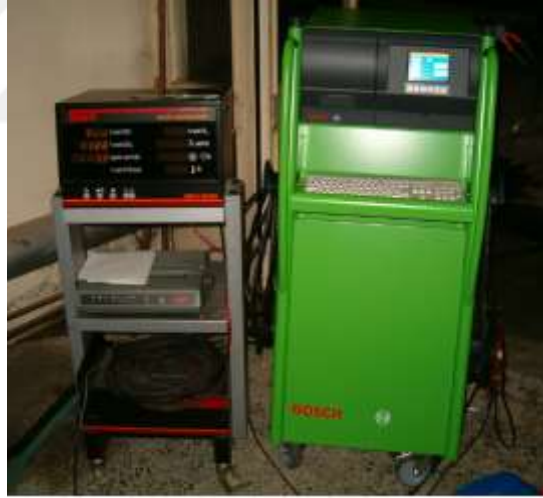
Şekil 5.6. Egzoz Emisyon Cihazları (Sun MGA 1200 ve Bosch BE 170)
