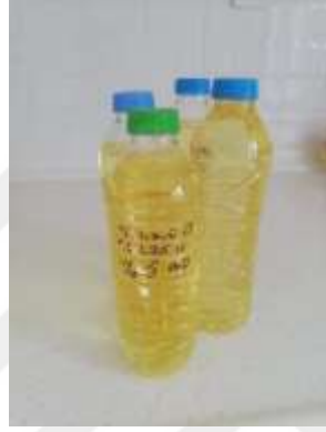
Şekil 5.12. %47,5 Biyodizel %47,5 Dizel %5 n-Bütanol Yakıt Karışımı
