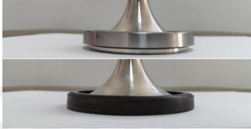
Şekil 6.2. Kullanılmamış ve hasarlı baganın sırasıyla supapla ilişkisi
