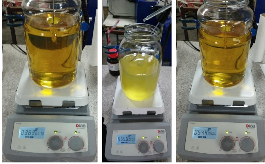
Resim 3.6 a) Standart dizel yakıtı karıştırma sonu, b) Sürfaktan ekleme işlemi, c) Yakıt+Sürfaktan karıştırma sonu.
