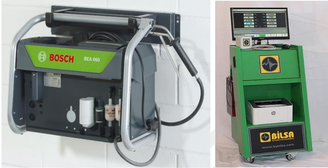
Şekil 3.2 a) Bosch BEA060 egzoz emisyonu ölçüm cihazı, b) Bilsa Mod2210 WinXP egzoz emisyonu ölçüm cihazı.
