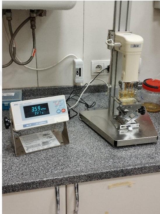
Resim 3.4 And Vibro SV-10 viskozite ölçüm cihazı.
