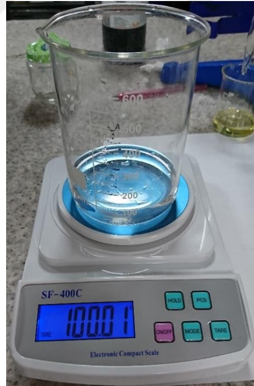
Resim 3.3 a) DLAB MS7-H550-Pro Isıtıcılı manyetik karıştırıcı, b) SF-400C Elektronik hassas terazi.
