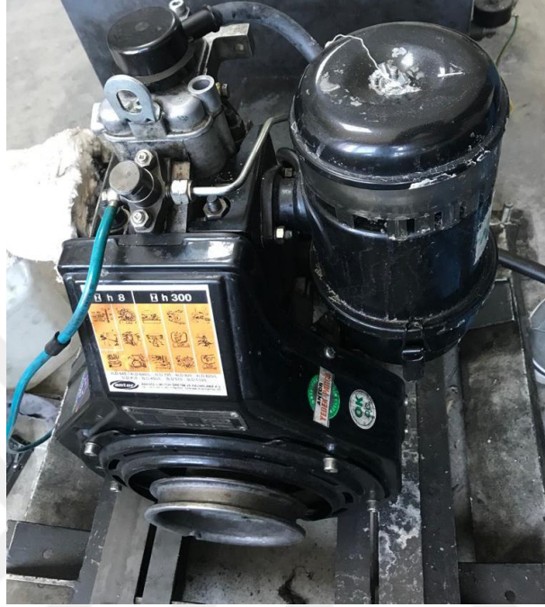
Resim 3.1 Deney motoru (Antor 3LD 510 12hp-8,84 kW).
