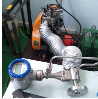
Şekil 5.6 Emme havası devresi üzerinde yapılan değişiklikler (Kişisel arşiv, 2020)
