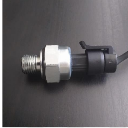
Şekil 5.11 Egzoz karşı basınç sensörü (Kişisel arşiv, 2020)
