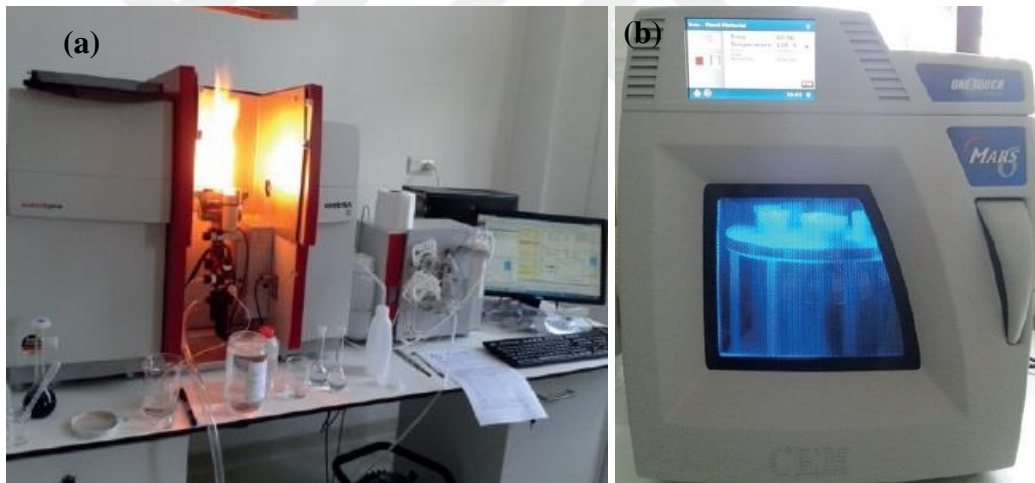
Şekil 3.5. Çalışmada kullanılan atomik absorpsiyon spektrometresi (AAS) a) Analitik Jena-ContrAA 300 ve b) CEM-Mars 6 cihazları.
