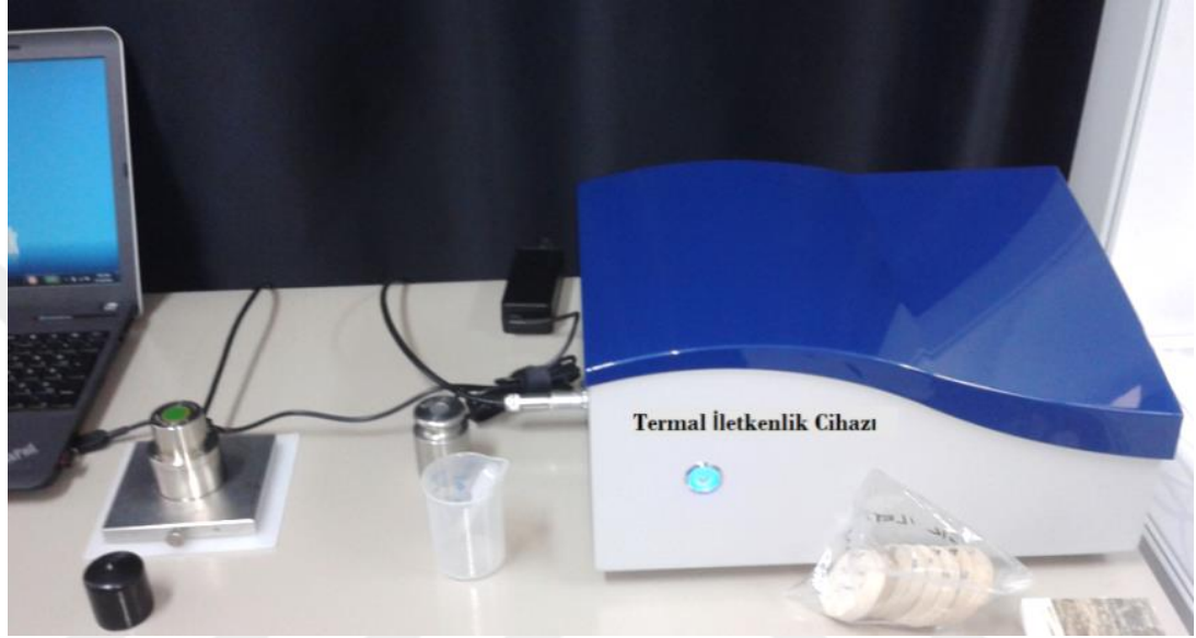
Şekil 3.10. Çalışmada kullanılan C-Therm marka termal analiz cihazı.
