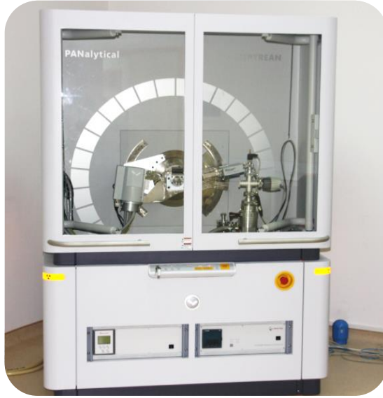
Şekil 3.6. Çalışmada kullanılan Panalytical Empyrean model X-ışını difraksiyon (XRD) cihazı.
