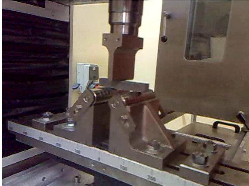
Şekil 3.8. 3-Nokta eğme test düzeneğinin şematik görünümü.
