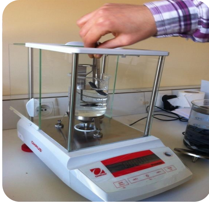
Şekil 3.9. Arşimet prensibi ile yoğunluk ölçümü deney düzeneği.
