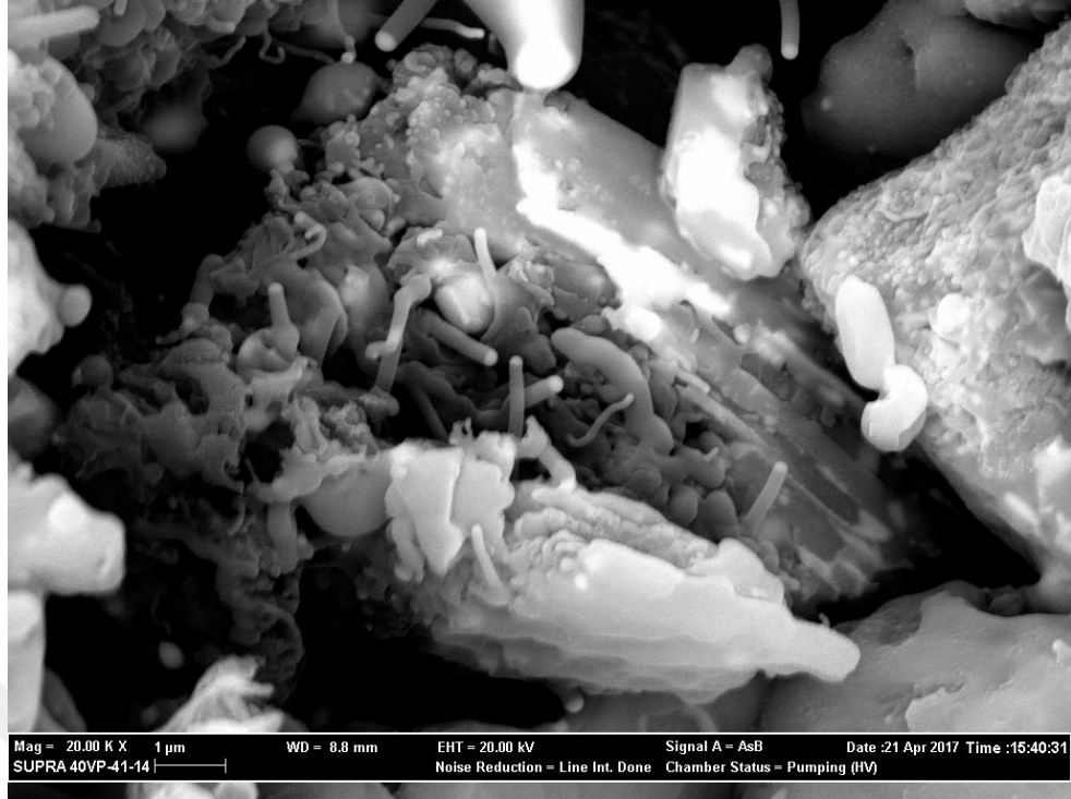
Şekil 4.12. 1600°C tepe sıcaklığında 120 dakika boyunca sinterlenmiş \alpha -12 kompozisyonunun 20 000 kez büyütme taramalı elektron mikroskop (SEM) görüntüsü.
