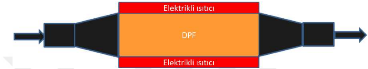
Şekil 2.11. Elektrikli ısıtıcı kullanarak DPF aktif rejenerasyonu (Lemon, 2014).
