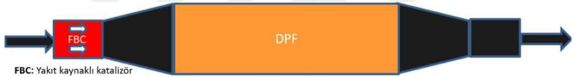
Şekil 2.15. Yakıt kaynaklı katalizör kullanarak DPF pasif rejenerasyonu (Lemon, 2014).
