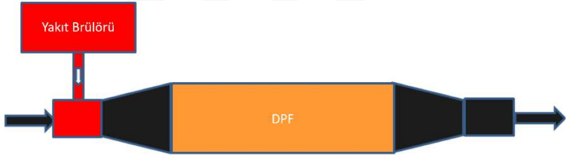
Şekil 2.12. Yakıt brülörü kullanarak DPF aktif rejenerasyonu (Lemon, 2014).
