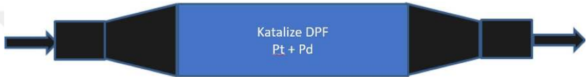
Şekil 2.14. Katalize DPF kullanarak DPF pasif rejenerasyonu (Lemon, 2014).
