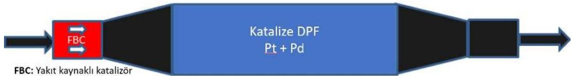
Şekil 2.16. Yakıt kaynaklı katalizör ve katalize DPF'i beraber kullanarak DPF pasif rejenerasyonu (Lemon, 2014).
