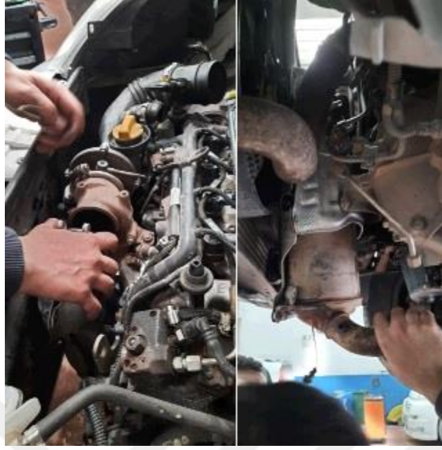
Resim 3.6 DPF deney aracına takılma işlemi.
