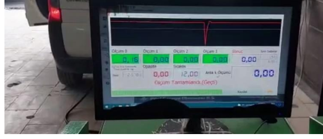
Resim 4.2 Deney aracın DPF temizleme sonrası egzoz emisyon ölçümü.
