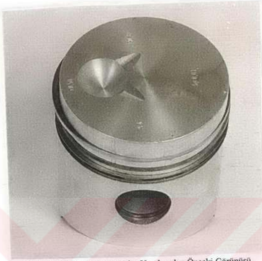
Resim 5.37. Pistonun Deneyler Yapılmadan Önceki Görünüşü.
