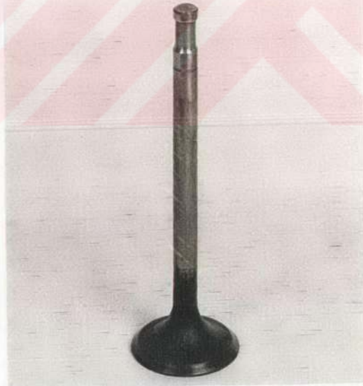
Resim 5.42. Motorin ile 100 Saatlik Çalışma Sonunda Egzoz Supabının Görünüşü.
