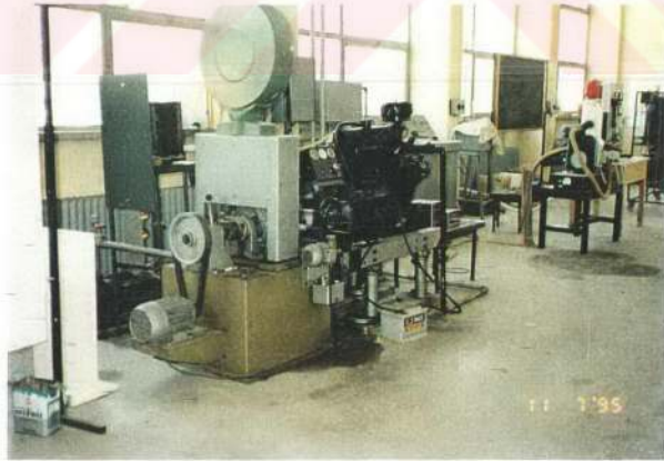
Resim 4.3. Deney Motoru ve Dinamometre.
