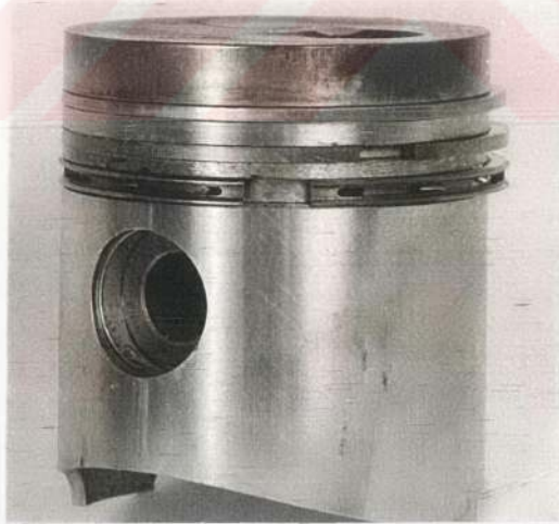
Resim 5.46. Motorin ile 100 Saatlik Çalışma Sonunda Piston Yan Yüzeyinin Görünüşü.
