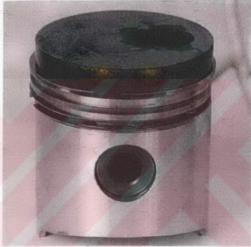
Resim 5.59. %25 Pamuk Yağı + %75 Motorin ile 100 Saatlik Çalışma Sonunda Pistonun Görünüşü.
