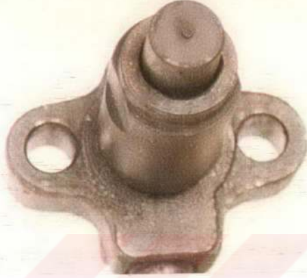
Resim 5.49. Motorin ile 100 Saatlik Çalışma Sonunda Enjektörün Görünüşü.
