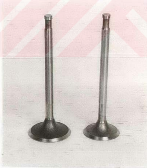
Resim 5.36. Emme ve Egzoz Supabının Deneyler Yapılmadan Önceki Görünüşü.
