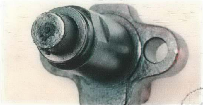
Resim 5.60. %25 Pamuk Yağı + %75 Motorin ile 100 Saatlik Çalışma Sonunda Enjektörün Görünüşü.
