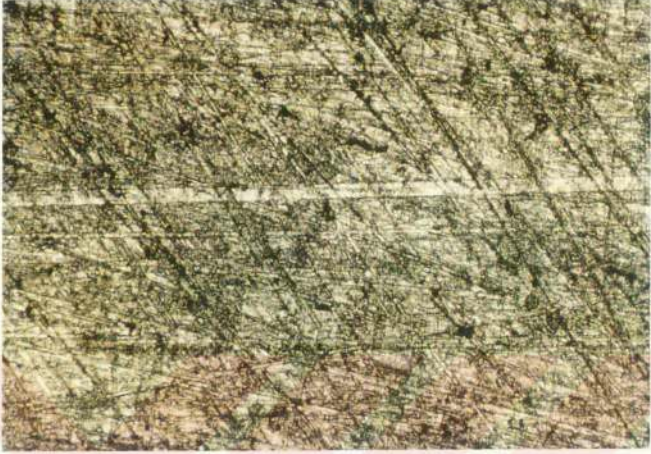
Resim 5.11. Motorin ve Pamuk Yağı İçerisinde Bekletilmiş Kompresyon Segmanı Yüzeyinin Mikroskop Altındaki Görüntüsü.
