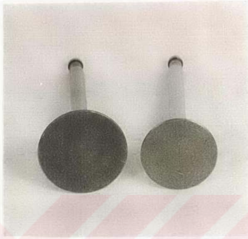
Resim 5.35. Emme ve Egzoz Supabının Deneyler Yapılmadan Önceki Görünüşü.
