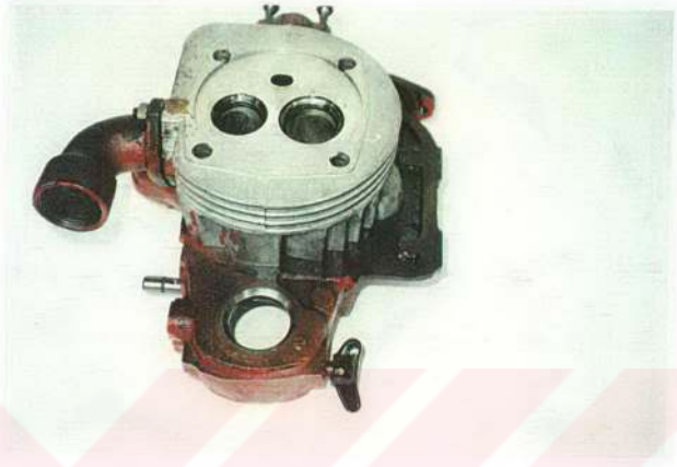
Resim 5.33. Silindir Kafası ve Yanma Odasının Deneyler Yapılmadan Önceki Görünüşü.
