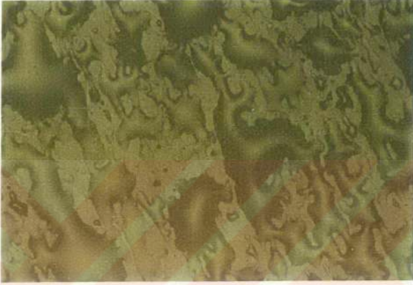
Resim 5.24. ıslı Cam Üzerine Püskürtülen %50 Pamuk Yağı + %50 Motorin Karışımı Damlacıklarının Görüntüsü. ( Püskürtme Açıklığı 20 cm. )
