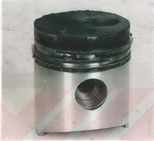
Resim 5.62. %50 Pamuk Yağı + %50 Motorin ile 100 Saatlik Çalışma Sonunda Pistonun Görünüşü.
