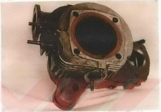
Resim 5.41. Motorin ile 100 Saatlik Çalışma Sonunda Silindir Kafasının Görünüşü.
