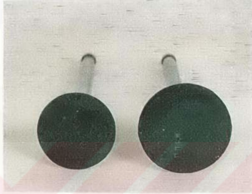
Resim 5.75. %75 Pamuk Yağı + %25 Motorin ile 100 Saatlik Çalışma Sonunda Emme ve Egzoz Supabının Görünüşü.
