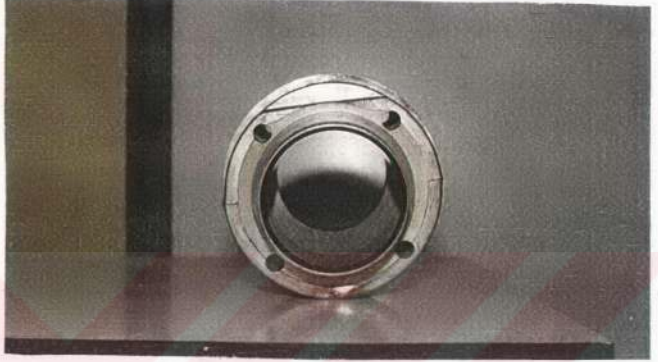
Resim 5.55. %25 Pamuk Yağı + %75 Motorin ile 100 Saatlik Çalışma Sonunda Gömleğin Görünüşü.
