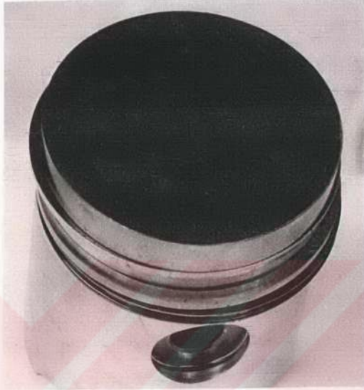
Resim 5.57. %25 Pamuk Yağı + %75 Motorin ile 100 Saatlik Çalışma Sonunda Pistonun Görünüşü.
