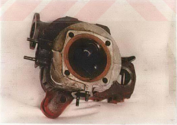
Resim 5.40. Motorin ile 100 Saatlik Çalışma Sonunda Silindir Kafasının Görünüşü.
