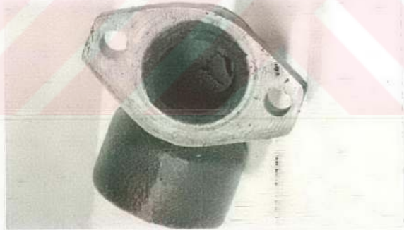
Resim 5.76. %75 Pamuk Yağı + %25 Motorin ile 100 Saatlik Çalışma Sonunda Egzoz Manifoldunun Görünüşü.
