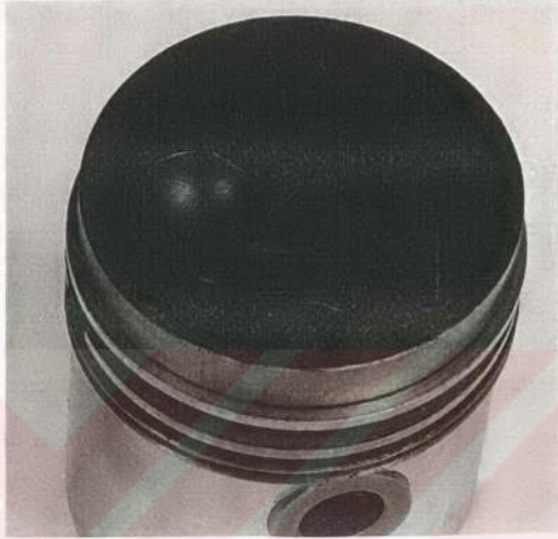
Resim 5.47. Motorin ile 100 Saatlik Çalışma Sonunda Piston Tablasının Görünüşü.
