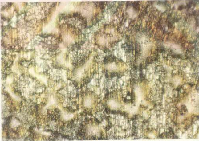
Resim 5.4. Ayçiçek Yağı İçerisinde Bekletilmiş Piston Yüzeyinin Mikroskop Altındaki Görüntüsü.
