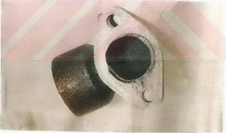
Resim 5.56. %25 Pamuk Yağı + %75 Motorin ile 100 Saatlik Çalışma Sonunda Egzoz Manifoldunun Görünüşü.
