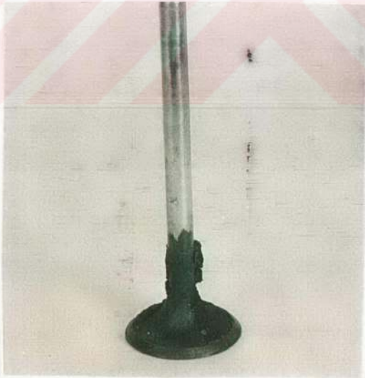
Resim 5.74. %75 Pamuk Yağı + %25 Motorin ile 100 Saatlik Çalışma Sonunda Emme ve Egzoz Supabının Görünüşü.
