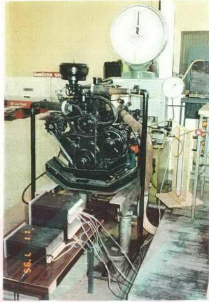
Resim 4.2. Deney Motoru ve Dinamometre.
