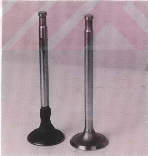
Resim 5.67. %50 Pamuk Yağı + %50 Motorin ile 100 Saatlik Çalışma Sonunda Emme ve Egzoz Supabının Görünüşü.
