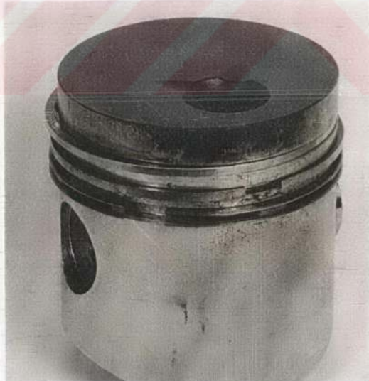
Resim 5.48. Motorin ile 100 Saatlik Çalışma Sonunda Piston Yan Yüzeyinin Görünüşü.
