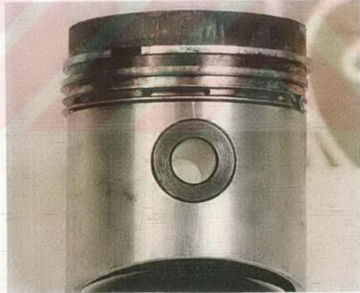
Resim 5.72. %75 Pamuk Yağı + %25 Motorin ile 100 Saatlik Çalışma Sonunda Pistonun Görünüşü.
