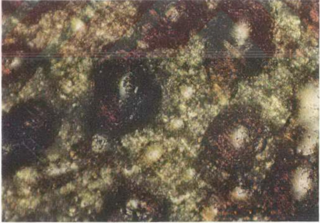
Resim 5.8. Ayçiçek Yağı İçerisinde Bekletilmiş Yağ Segmanı Yüzeyinin Mikroskop Altındaki Görüntüsü.
