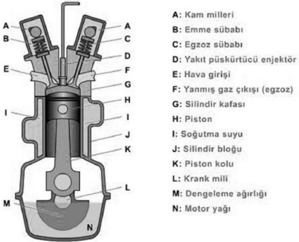
Şekil 4.1. Dizel motorun ateşleme sistemi elemanları (Toksöz, 2010)
