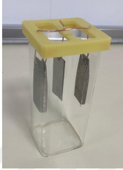
Şekil 5.1. Elektrokimyasal kaplama reaktörü ve bileşenleri
