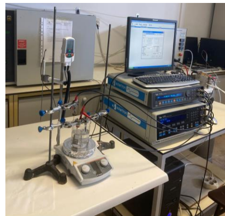
Şekil 5.4. Korozyon ölçüm hücresi ve deney düzeneği
