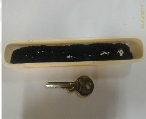
Şekil 7.8. 1450^\circ\text{C} 'de yapılan DKTİN işlemi sonrası ve karbon yakma işlemi öncesi alümina kayıkçı içine konulmuş \text{Si}_3\text{N}_4 esaslı reaksiyon ürünleri.
