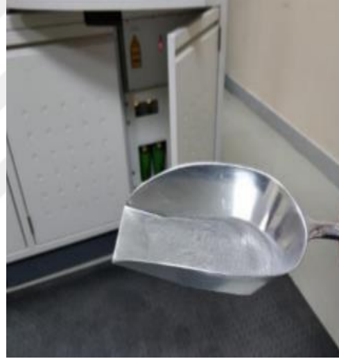
Şekil 6.1. EOS firması tarafından üretilmiş olan Ti64 tozunun paketli ve açık görünümü
