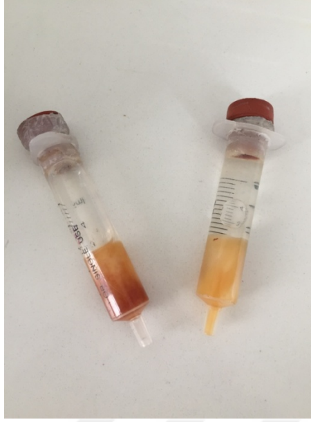
Şekil 4.2. EPS gömülü ve boş kriyojele Fe^{3+} iyonlarının immobilizasyonu sonucu oluşan kriyojeller.
