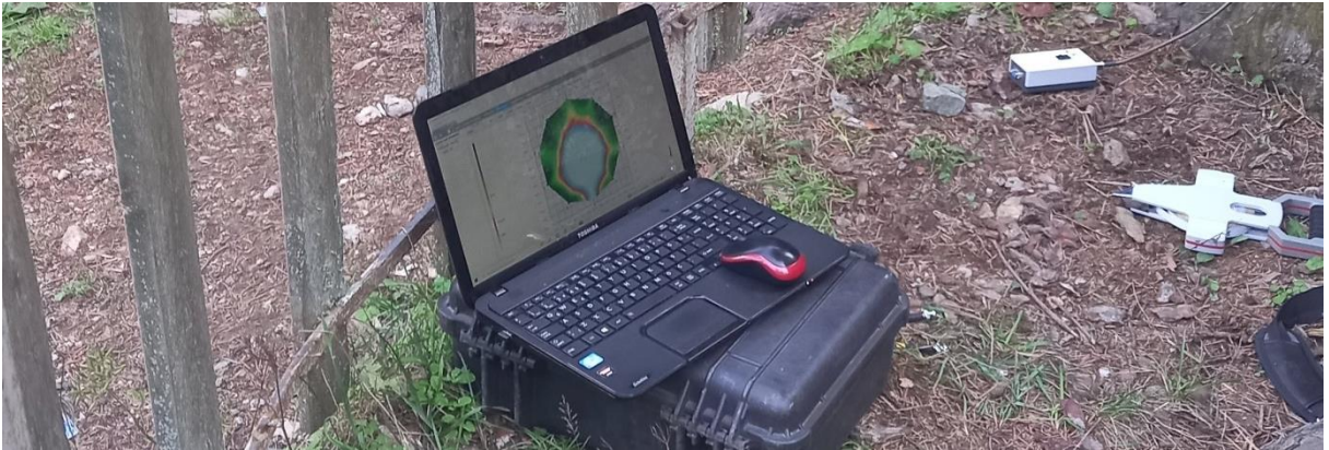
Şekil 9. Tomografi Cihazının Bilgisayar Bağlantısı
