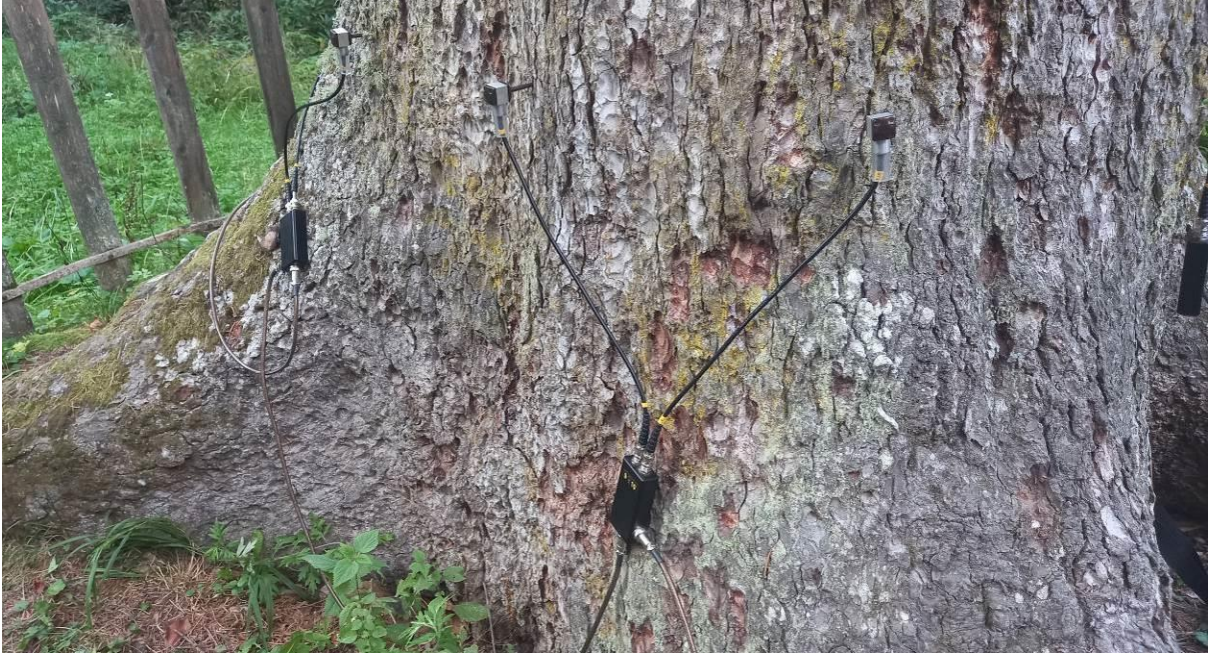
Şekil 8. Sensörlerin Birleri ve Ağaçla Bağlantısı
