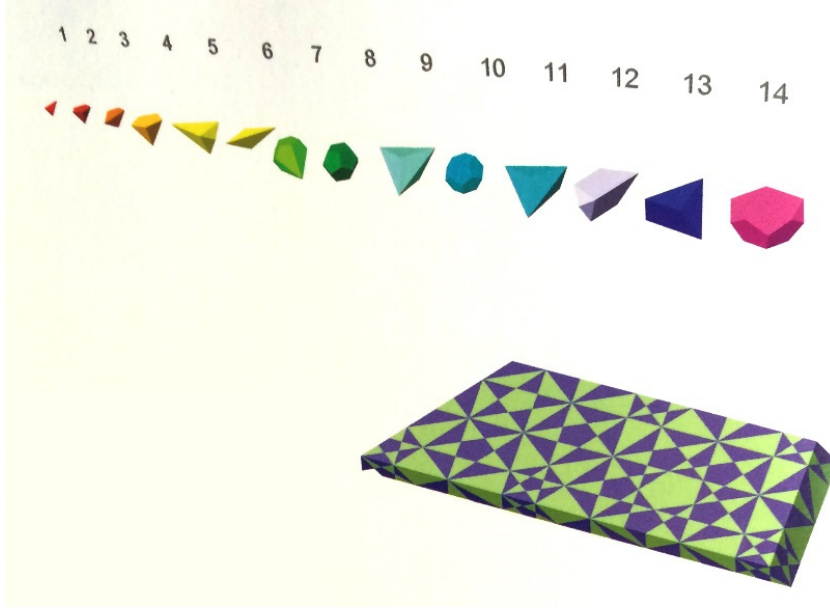
Şekil 4.25: Mekanı Amman düzlemleriyle bölerek oluşturulmuş 14 polidehral karo (Burry & Burry, 2010).
