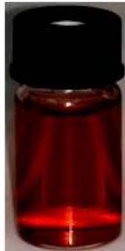
Şekil 3.8. DSSC'de kullanılmak üzere hazırlanan sıvı redoks elektroliti
