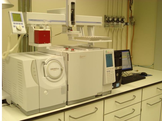
Şekil 3.16. GC-MS Sistemi analizlerinde kullanılan Shimadzu OP2010 Ultra GC-MS cihazının fotoğrafı
