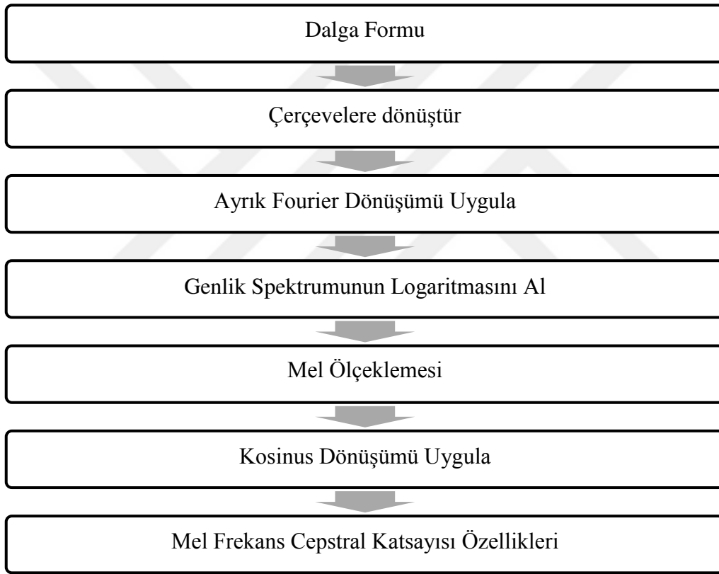
Şekil 31. Mel Frekans Cepstral Katsayısı Oluşturma Algoritması
