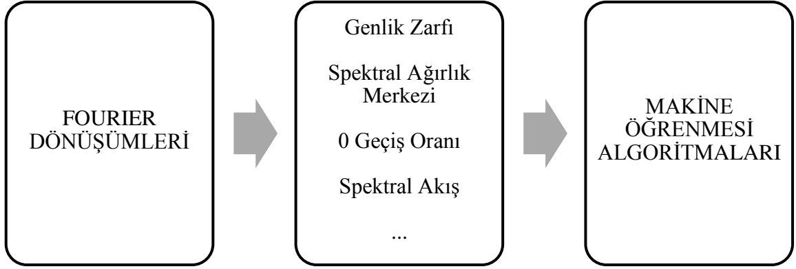
Şekil 32. Ses Verileri İçin Geleneksel Makine Öğrenmesi Akışı
