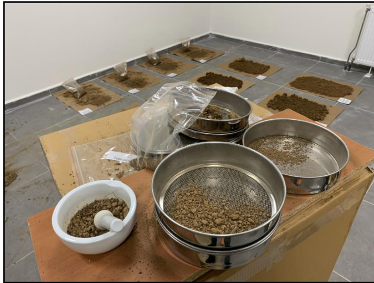
Şekil 56. Toprak örneklerinin havanda dövme ve 2 mm'lik çelik elek ile analize hazırlanması işlemi
