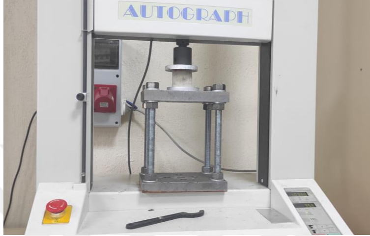
Resim 3.10 Basma deneyinde kullanılan cihaz.
