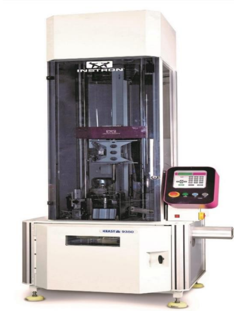
Resim 3.8 Çalışmada tercih edilen darbe test cihazın görseli (İnt.Kyn.12).
