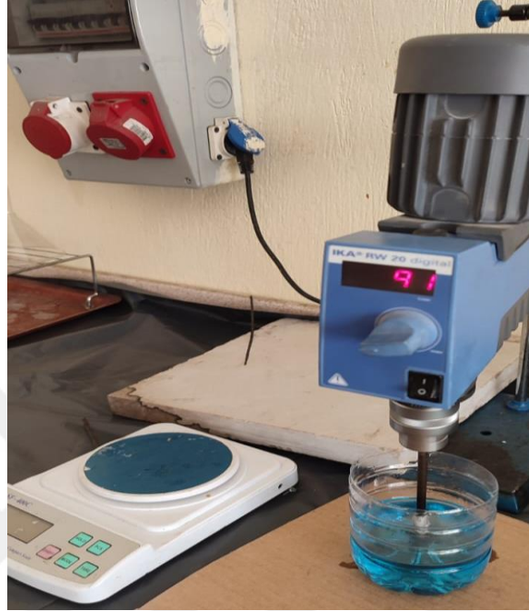
Resim 3.6 Epoksi reçine karıştırma işlemi ve hassas tartı.
