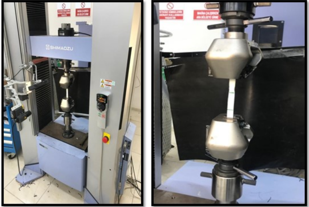
Şekil 3.8 Testlerin yapıldığı çekme makinesi (Kişisel arşiv, 2019)
