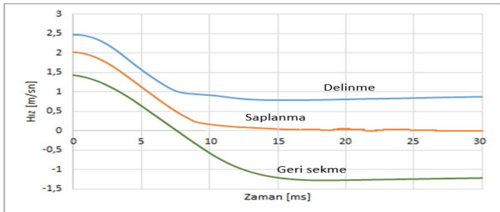
Şekil 3.14 Farklı darbe enerjilerinde hız-zaman eğrileri
