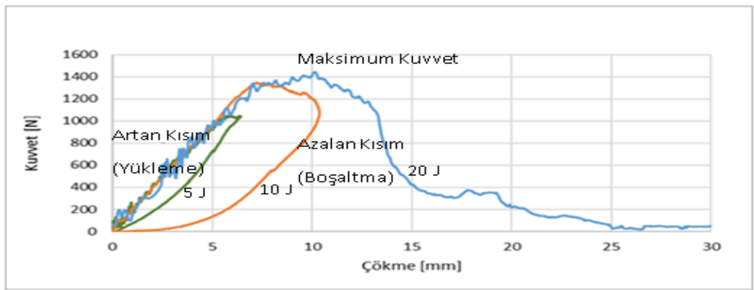
Şekil 3.11 Farklı darbe enerjilerinde kuvvet çökme eğrileri
