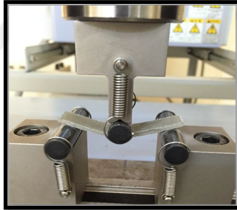
Şekil 3.16 Eğilme testi uygulaması (Kişisel arşiv, 2019)
