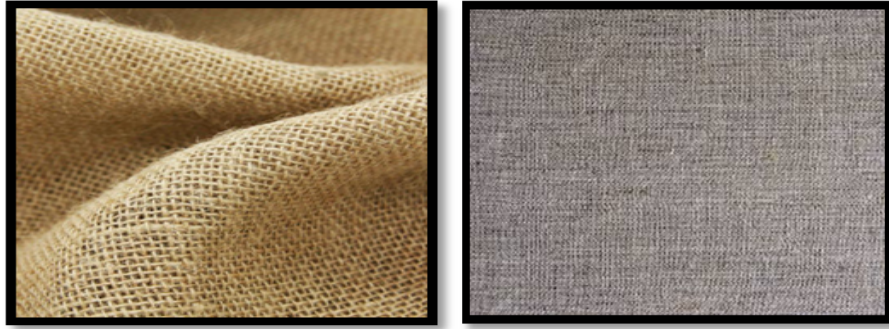
Şekil 3.1 Takviye elemanları dokuma jüt ve dokuma keten kumaş (Kişisel arşiv, 2020)
