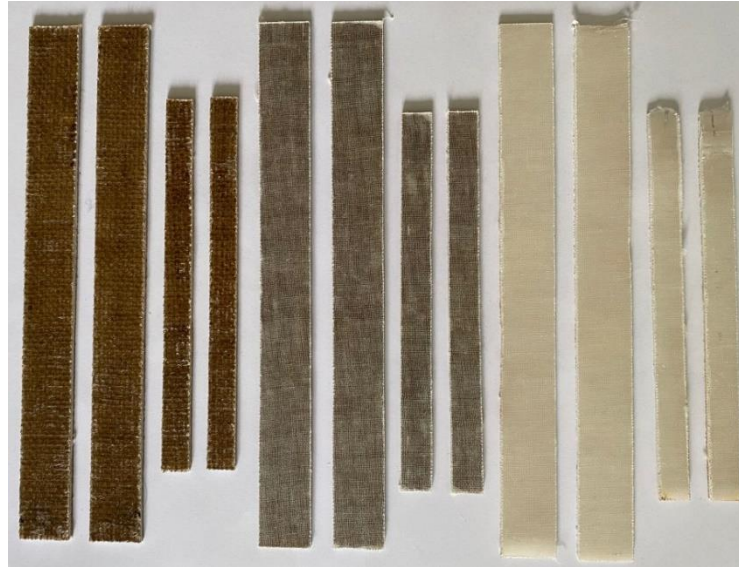
Şekil 3.9. K1, K8 ve K3 numunelerinin çekme ve eğilme test numuneleri
