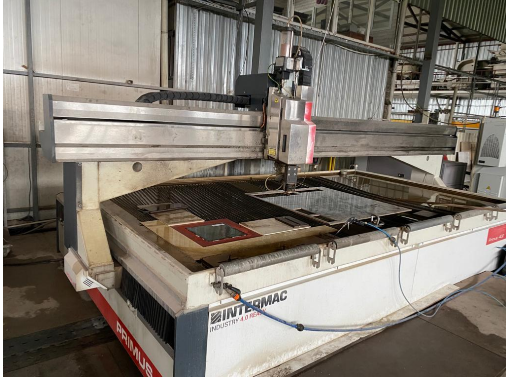
Şekil 3.7. Numune kesme işleminin yapıldığı su jeti cihazı
