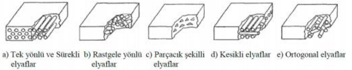
Şekil 1.7. Farklı şekilli elyaf takviyeli kompozitler (Şahin, 2006)
