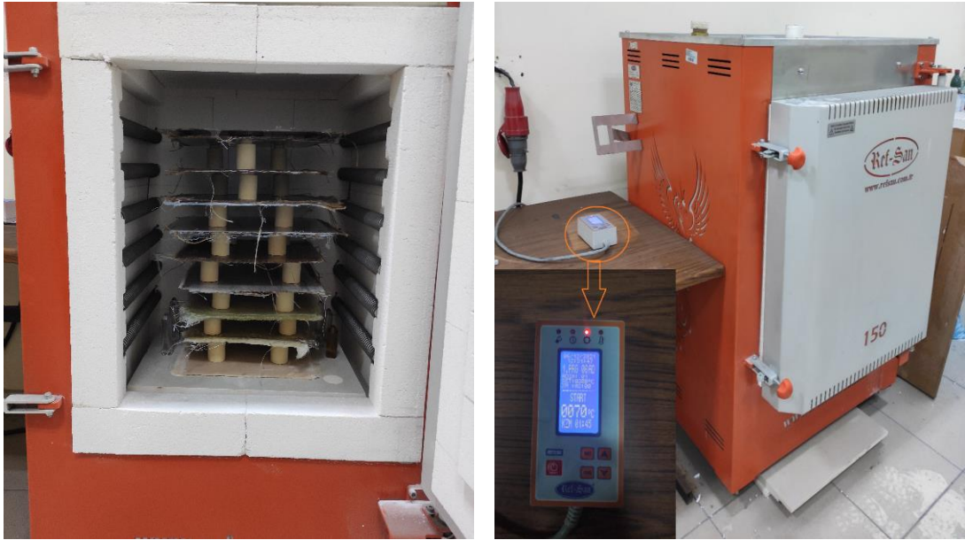
Şekil 3.6. Kompozitlerin fırın içerisinde tam kürlenmeye bırakılması
